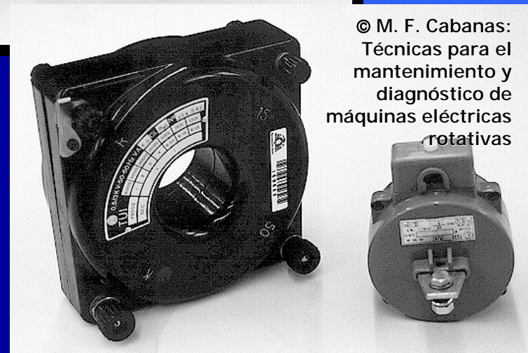
Transformadores de corriente 100 A
