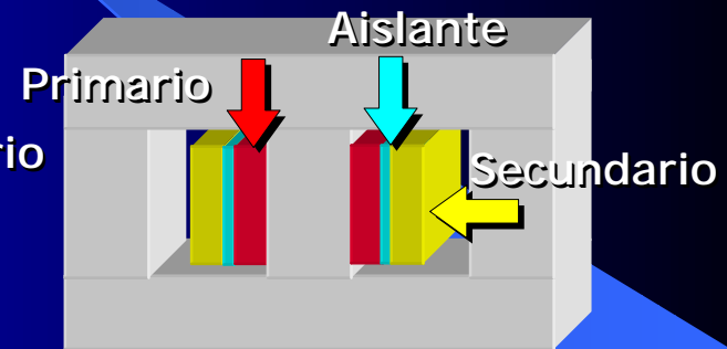
Núcleo con 3 columnas
