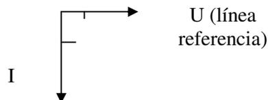
Ejemplo: determinar la intensidad de corriente de un circuito inductivo puro que tiene una bobina de 10 Hy, conectado a una fuente de 220 voltios 50 Hz.
