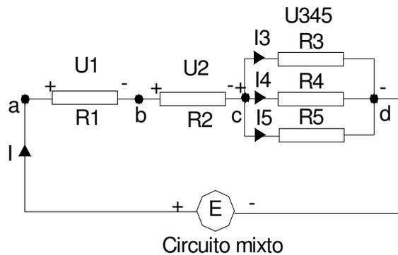
Para hallar la resistencia equivalente  $R$  del circuito mixto, se calcula primero  $R'$  equivalente del sistema en paralelo ( $R_3, R_4, R_5$ ) y esta  $R'$  sumada con las  $R_1, R_2$  que están conectadas en serie con ella nos dan la  $R$  buscada.
