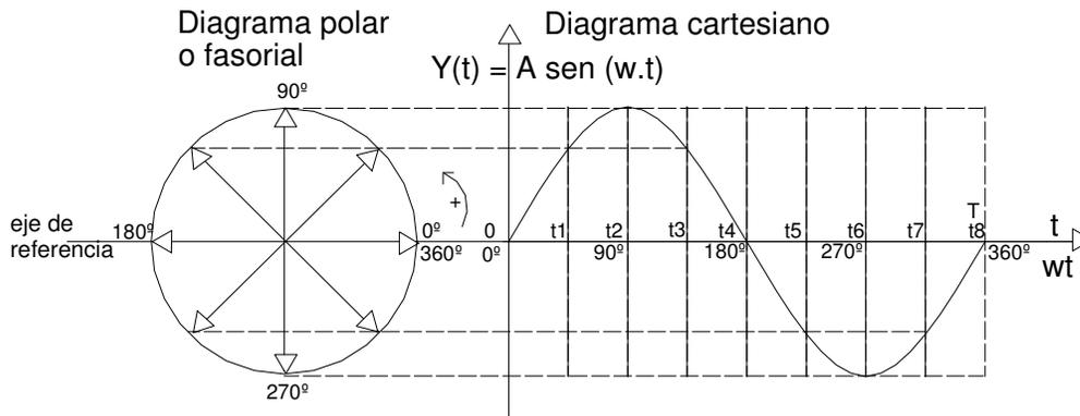
En la siguiente figura, se representa una magnitud de tensión alterna en forma polar con su módulo y argumento respecto a una línea de referencia en sentido anti horario donde se considera el punto de arranque de la onda y el círculo de rotación representado por su amplitud máxima. Este vector rotatorio gira a una velocidad angular constante de valor  $\omega$ .
