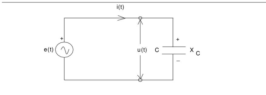
Ejemplo: para el circuito capacitivo puro anterior determinar la intensidad de corriente si  $C = 1 \mu F$ ,  $U = 220V$  y  $f = 50Hz$ .
