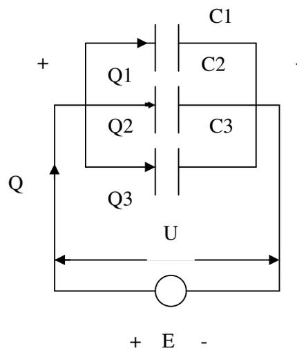
Cuando se cierra el circuito, se establece una corriente que carga simult3neamente a los tres capacitores a trav3s de un punto com3n de uni3n o nodo indicado por las flechas.
