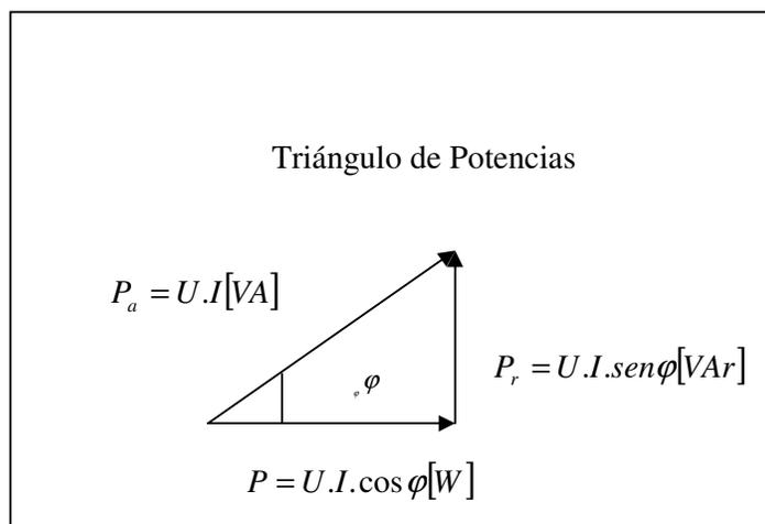
$P_r = U.I. \sen \varphi$  se denomina Potencia reactiva y se mide en volt-amper reactivos [VAr]. La potencia aparente  $P_a$  se mide en volt-amper [VA] y es la que suministra el generador o fuente para cubrir los requerimientos de la carga determinados por  $P$  y  $P_r$ , de lo que se deduce que  $\varphi$  debe ser lo más pequeño posible (en el caso ideal igual a cero), haciendo que  $P_r$  disminuya en magnitud. Es por ello la importancia del factor de potencia en un circuito de C.A.
