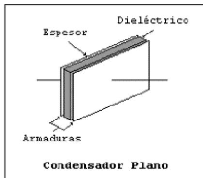
También se pueden definir los condensadores como dispositivos formados por dos placas o láminas conductoras separadas por un dieléctrico, construidos especialmente para ofrecer una capacidad determinada.
