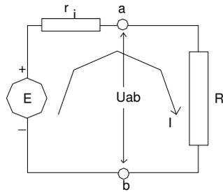
Ejemplo: determinar la tensión en bornes de un generador que tiene una fem de 12 Voltios, si posee una resistencia interna de 0.1 Ω y por el circuito se establece una intensidad de corriente de 1 Amper.
