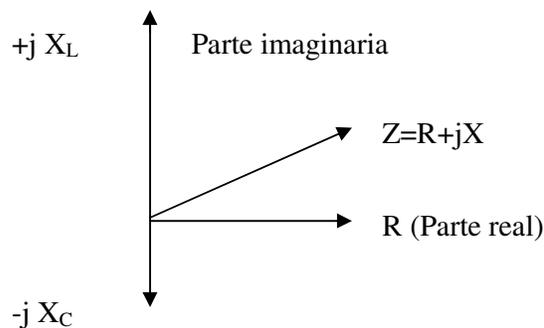
Ejemplo: una carga RLC tiene los siguientes valores:  $R = 50 \Omega$ ,  $X_L = 100\Omega$ ,  $X_C = 50\Omega$ . Representar la impedancia de carga con el módulo y argumento de la función y como un número complejo.
