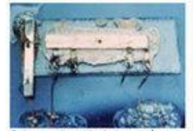
Primer circuito integrado (1958) inventado por J. Kilby de Texas Instruments. Por primera vez se incluyeron varios componentes electrónicos en un único dispositivo.
