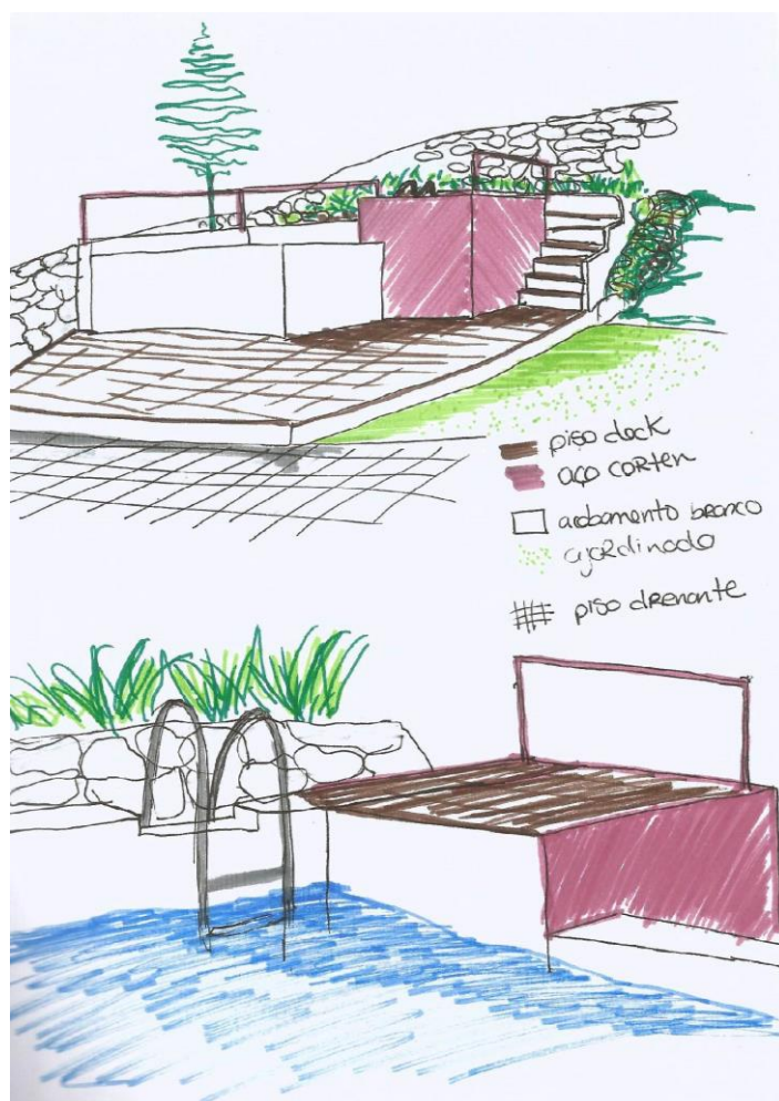
Figura 60. Esquissos da reabilitação do tanque
