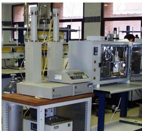
Fig.58- Equipo dinámico de determinación de solubilidades de sólidos en FSC.
