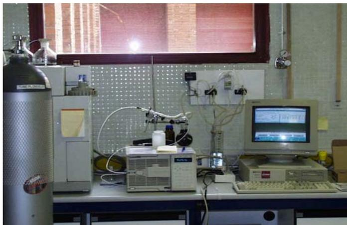
Fig.57- Extractor con fluidos supercríticos Hewlett Packard SFE 7680T.
