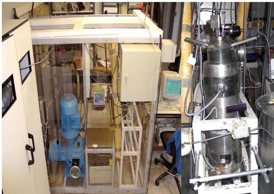
**Fig.56- Planta Piloto de Extracción con FSC (extractor de 2 litros, especificaciones máximas de presión y temperatura: 70 MPa y 200°C)**
