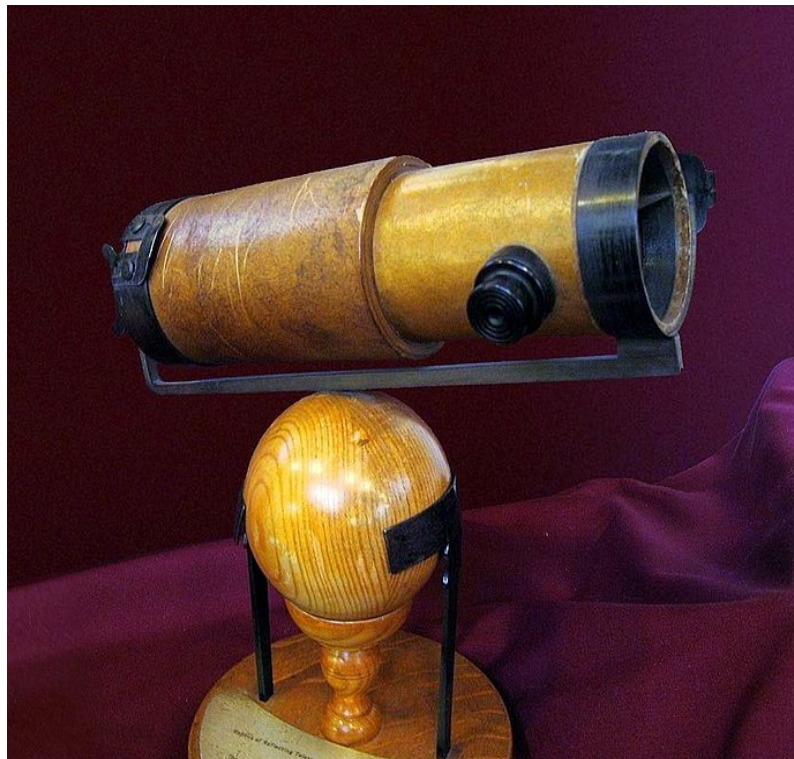
Reconstrucción del telescopio reflectante que Isaac Newton construyó en 1672. (Autor Andrew Dunn, 5 /11/ 2004).
