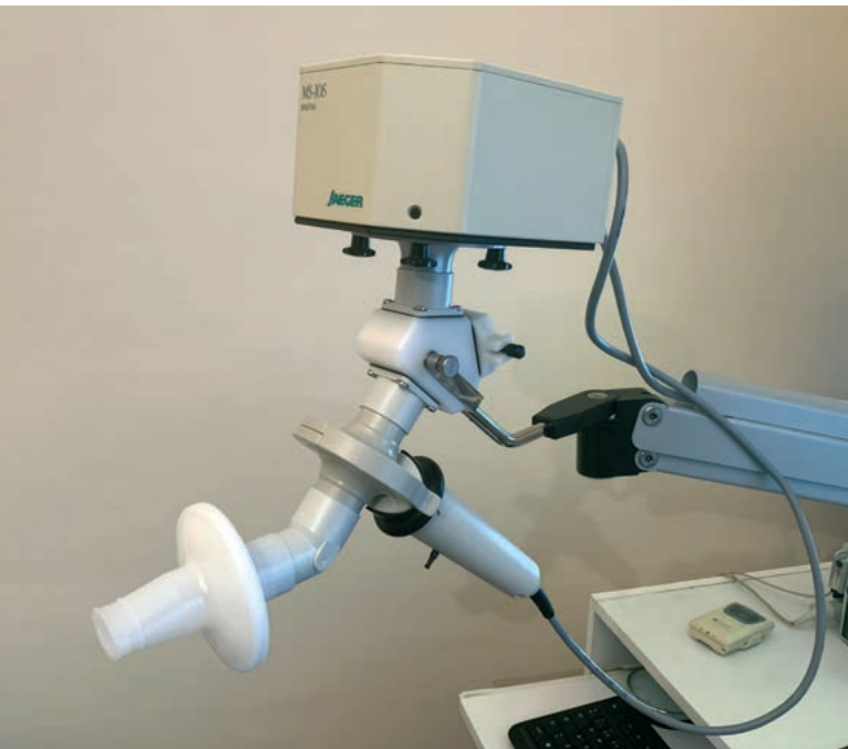
Figura 1. Neumotacógrafo con oscilómetro acoplado
