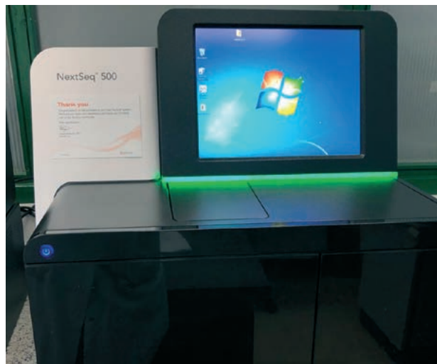
Figura 3. Equipo de secuenciación masiva NextSeq 500 que permite realizar secuenciaciones de exomas (ADN que codifica proteínas), genomas completos (ADN) y transcriptomas (ARN)
