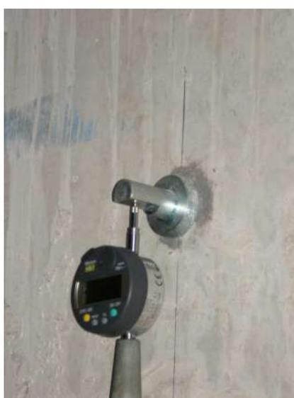
Figura 4.10 – Pino superior fixado no pilar
