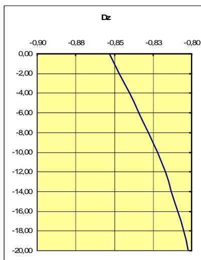
Figura 3.28 – Deslocamento vertical da estaca central
