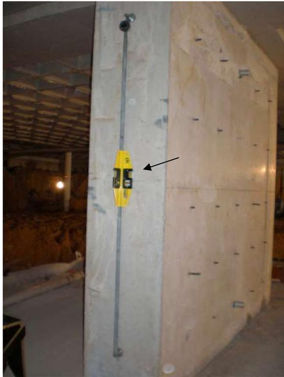
Figura 4.8 – Extensômetro removível
