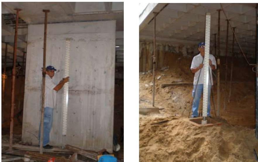
Figura 4.5 – Mira posicionada no pilar e na referência fixa de nível
