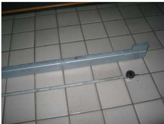
Figura 4.9 – Barra de referência padrão e extensômetro removível
