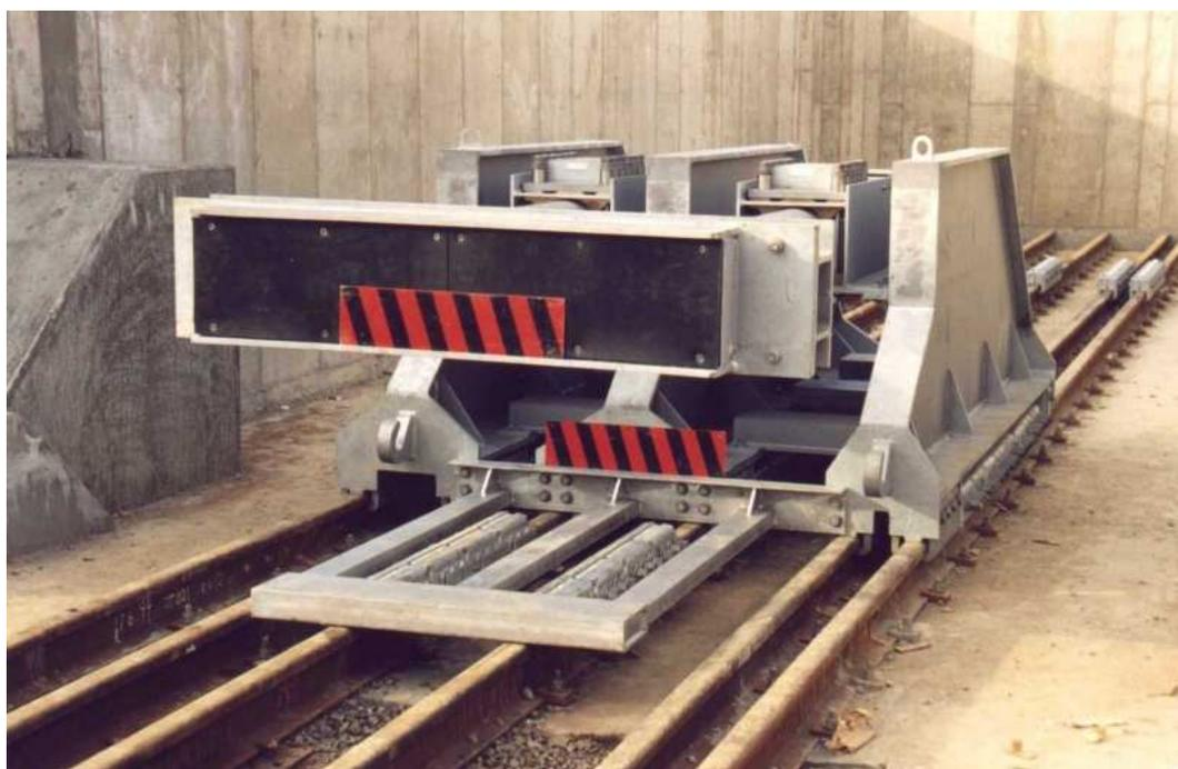
Figura 3.36 – Modelo de para-choque auto-frenante móvel de final de linha
