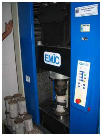
Figura 5.22 – Ensaio de determinação do módulo de elasticidade
