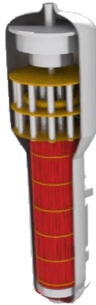
Figura 18. Generador de vapor
