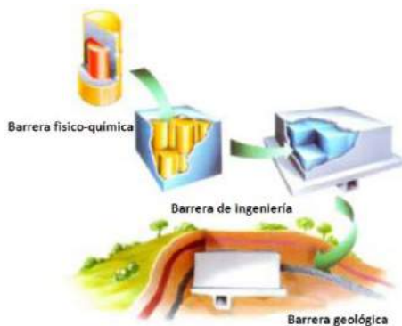
Figura 52. Representación de las distintas barreras de contención de la radiactividad de los RBMA
