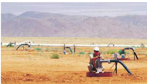
Figura 25. Una mina utilizando el método de ISL
