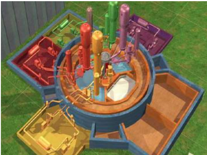
Figura 57. Reactor EPR y los cuatro trenes de seguridad
