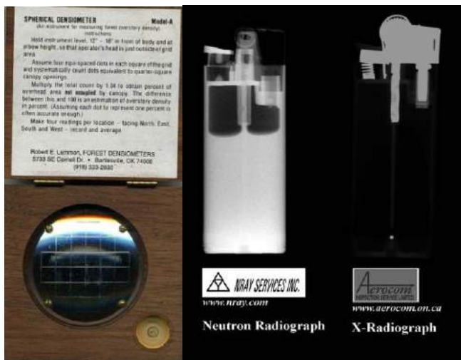
Figura 68. Densiómetro forestal para medir coberturas arbóreas (izq). Comparación entre una neutrografía y una radiografía de un mechero (dcha).
