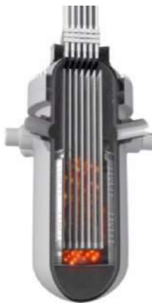
Figura 16. Barras de control introducidas dentro del reactor
