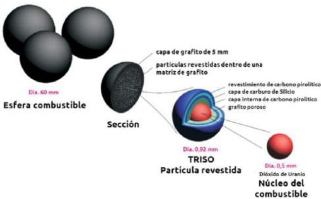
Figura 62. Combustible de los reactores de muy alta temperatura
