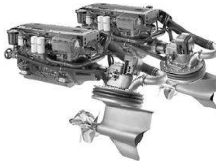
Figura 30. Modelo Volvo Penta IPS
