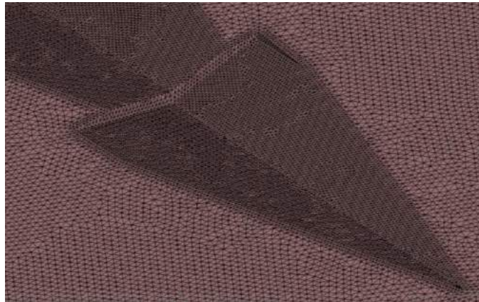
Figura 41. Mallado en la zona del escalón del buque
