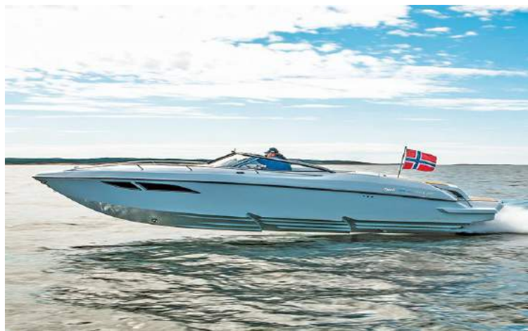
Figura 2. Barco escalonado con popa abierta
