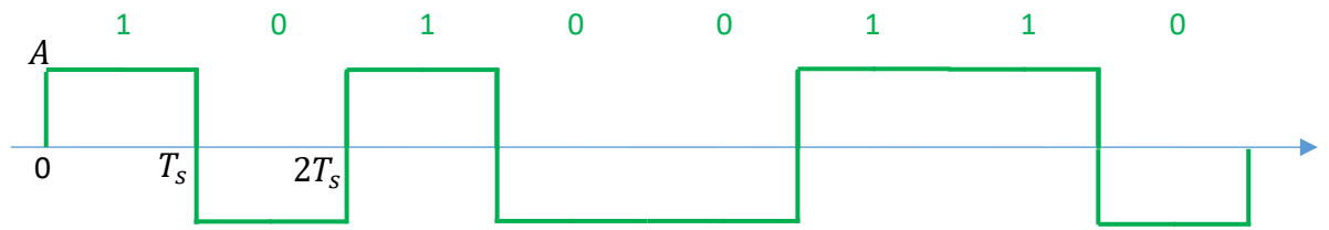
Figura 8. Exemplo de transmissão de sinal on-off NRZ.
