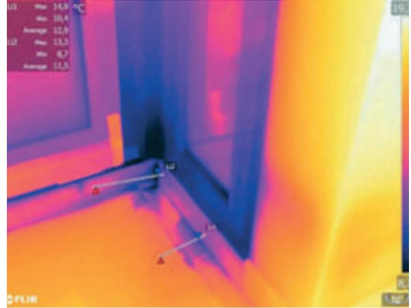
Figura 3.23. Termografía infrarroja que muestra el puente térmico debido a la falta de aislamiento en el alfeizar de ventana. Fuente: S. Melgosa Revilla. Guía de ventanas eficientes y sistemas de regulación solar. Fenercom.2016 [www.fenercom.com](http://www.fenercom.com)
