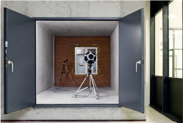
Figura 4.2. Banco de Ensayos Acústicos.
