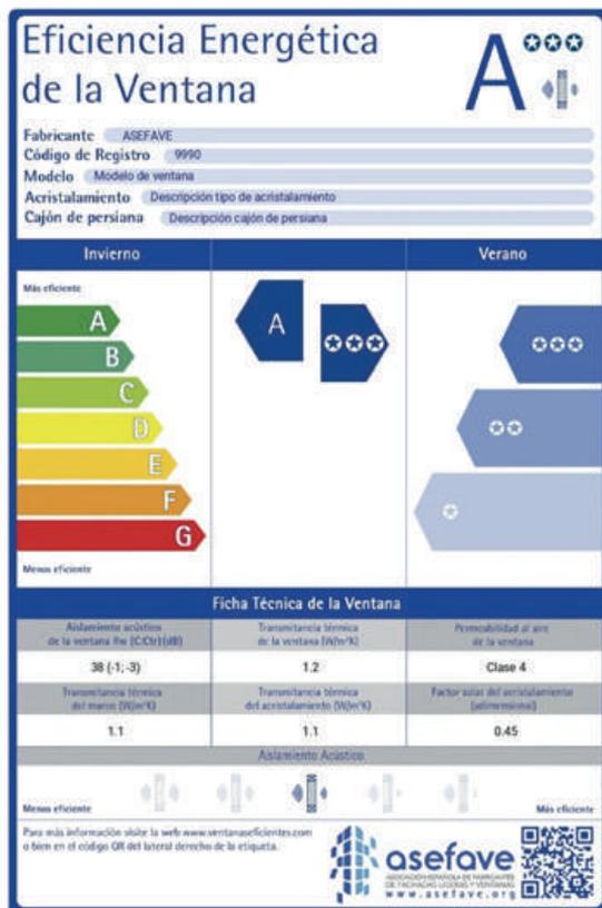
Figura 1.20. Etiqueta de Eficiencia Energética de la Ventana (EEV).
