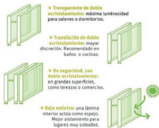
Figura 1.15. Diferentes tipos de vidrios dobles. Fuente: ALLA [ailla-alumini.com](http://ailla-alumini.com)
