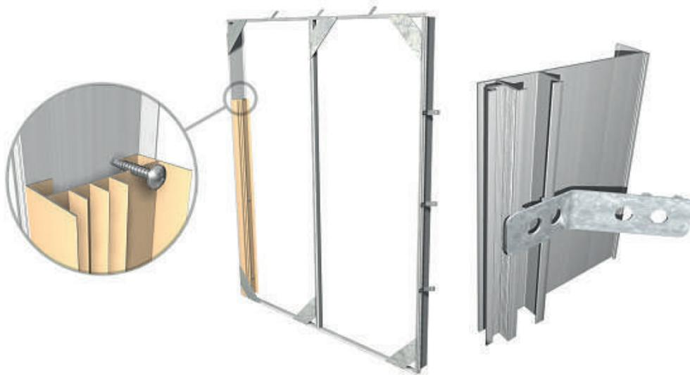
Figura 3.3. Cerco metálico con patillas de anclaje y marco atornillado.
