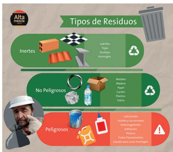
Figura 3.30. Tipos de residuos de construcción.
