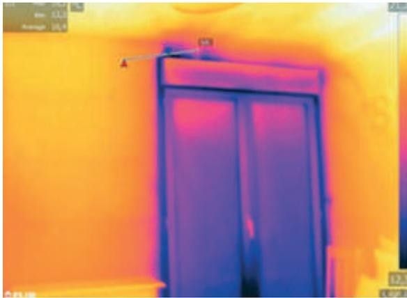
Figura 3.24. Termografía infrarroja que muestra el puente térmico debido a la entrada de aire por la parte superior de la ventana. Fuente: S. Melgosa Revilla. Guía de ventanas eficientes y sistemas de regulación solar Fenercom.2016 [www.fenercom.com](http://www.fenercom.com)
