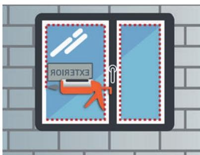
Figura 3.12. Aplicación de silicona para acristalamiento
