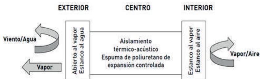
Figura 3.15. Esquema de aislamiento de una junta. Modelo de sellado en tres capas. Fuente: ASEFAVE. Guía de instalación de ventanas. 2019
