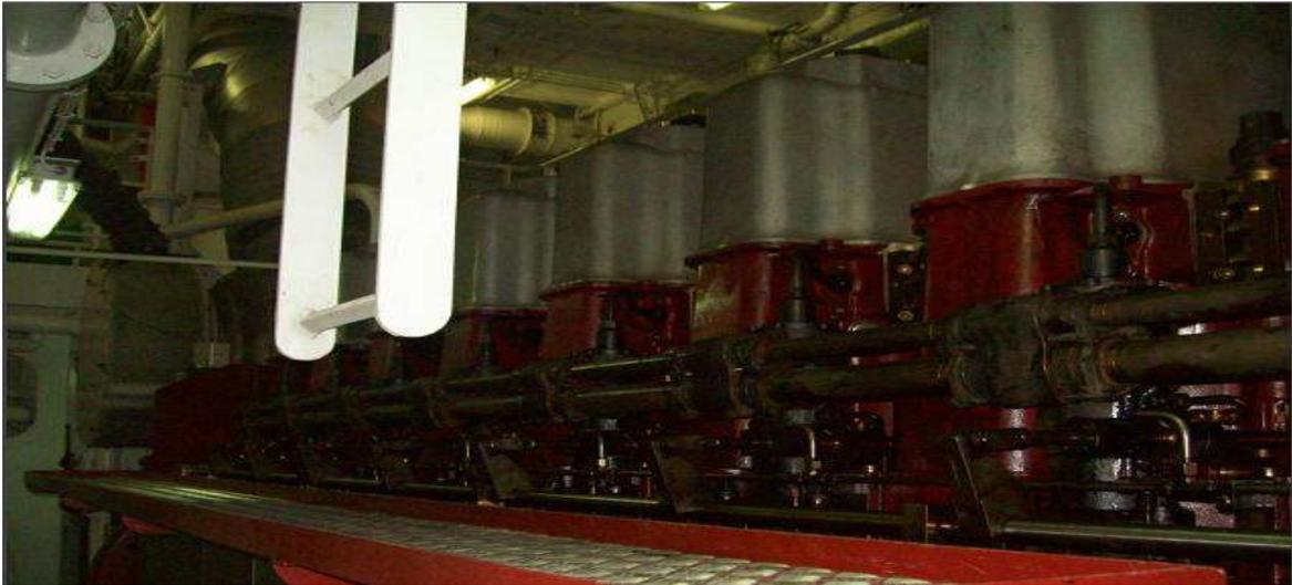
Este motor, está compuesto por un turbo cargador (ver ilustración 13) de alta eficiencia, que modera el nivel de temperatura de los componentes que rodean en la cámara de combustión. Y la finalidad es la de ingresar o empujar la mezcla dentro de los cilindros, aumentando la relación de compresión.
