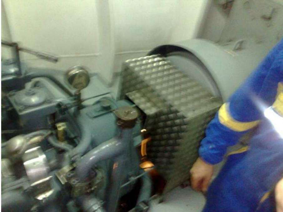
➤ Acople salida motor eje principal
