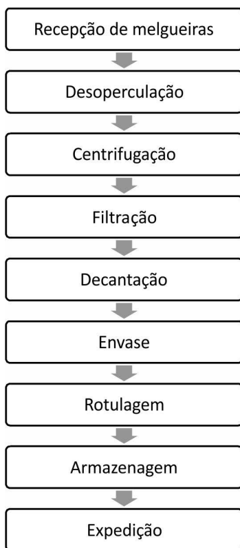
Figura 36. Fluxograma de extração do mel.
