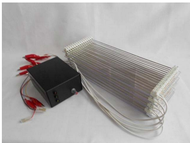
Figura 44. Equipamento elétrico utilizado para coleta de apitoxina, constituído de placa de vidro, eletroestimulador, pulsador e bateria.
