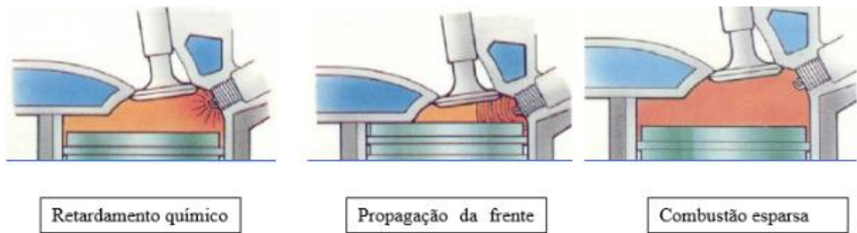
Figura 9: Início e propagação da reação de combustão
