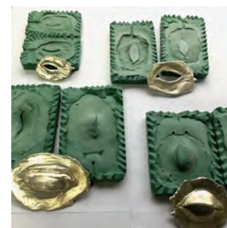
Figura 57. Moldes de peças fundidas.
