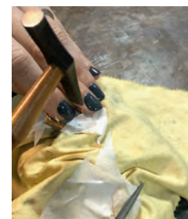
Figura 65. Rebitar os espelhos acrílicos a peça.
