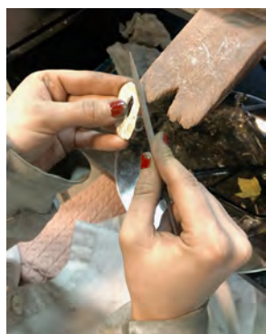
Figura 62. Retirar matéria para tornar a peça mais leve.
