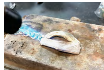
Figura 63. Soldar corrente ao olho.
