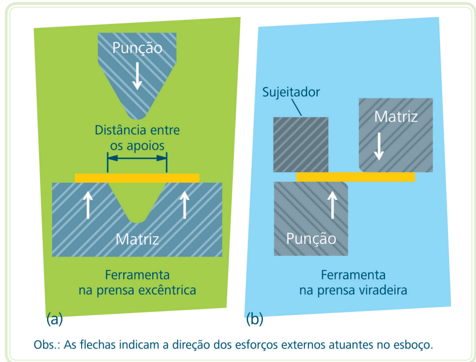
Figura 3.14: Ferramenta de dobramento adaptada à (a) prensa excêntrica ou à (b) prensa viradeira
