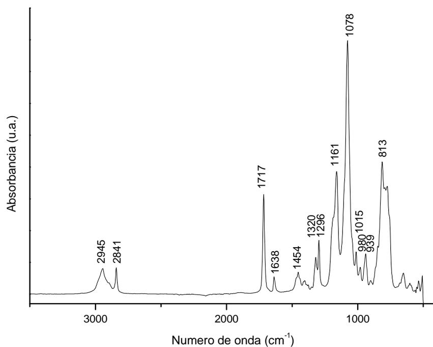
Figura 4.2. Espectro ATR del MPS puro.
