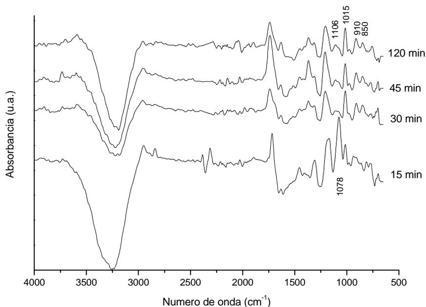
Figura 4.3. Espectro ATR de la disolución acuosa de MPS a pH 4 para diferentes tiempos de hidrólisis.
