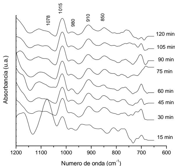
Figura 4.4. Detalle del espectro de ATR en la región  $1200\text{-}650\text{ cm}^{-1}$  de la disolución acuosa de MPS a pH 4 para diferentes tiempos de hidrólisis.
