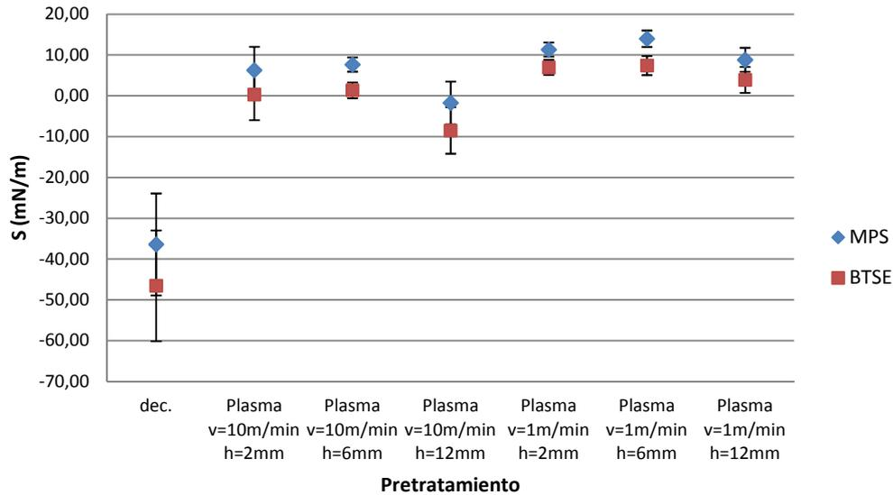
Figura 7.6. Presión de esparcimiento para la muestra decapada y aquella pretratadas con plasma (tiempo inmediato tras el pretratamiento) respecto a las disoluciones de MPS y BTSE.
