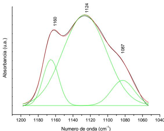
Figura 5.11. Deconvolución de la región comprendida entre  $1200$  y  $1060\text{ cm}^{-1}$  en el espectro de la muestra silanizada con BTSE durante 5 min de inmersión y curada a  $100\text{ }^{\circ}\text{C}$  durante 60 min.
