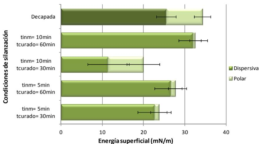
Figura 5.15. Energía libre superficial total, así como sus componentes polar y dispersiva, para la muestra decapada y las muestras silanizadas con una disolución BTSE al 1% en una mezcla de agua (93%) y metanol (6%) hidrolizada durante 72 h. Tiempos de inmersión: 5 y 10 min. Tiempos de curado a 100 °C: 30 y 60 min.
