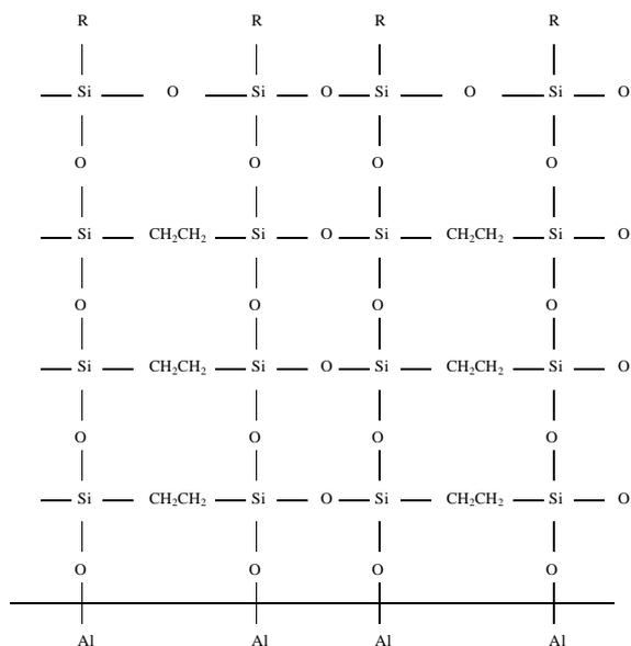
Figura 5.25. Esquema de la adsorción mediante el sistema de silanización de dos pasos mostrando una película no porosa.
