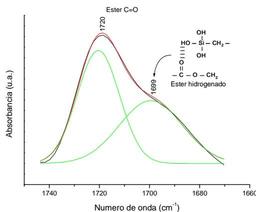
Figura 5.20. Deconvolución de la región entre  $1745$  y  $1650\text{ cm}^{-1}$  en el espectro de la muestra silanizada con una disolución acuosa a pH 4 de MPS al 1% hidrolizada durante 60 min. Tiempo de inmersión: 5 min. Tiempo de curado: 60 min a  $100\text{ }^{\circ}\text{C}$ .
