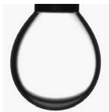
Figura 3.4. Método de la gota pendiente.
