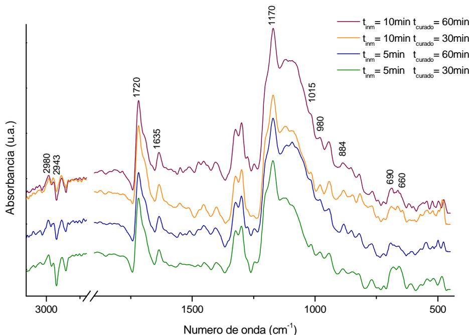
Figura 5.1. Espectros de RAIR de los recubrimientos de silano MPS sobre aluminio obtenidos a partir de una disolución acuosa a pH 4 al 1% de MPS hidrolizada durante 60 min. Tiempos de inmersión: 5 y 10 min. Tiempos de curado: 30 y 60 min a  $100^{\circ}\text{C}$ .
