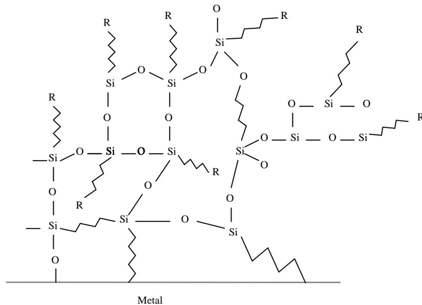
Figura 1.4. Formación de oligómeros complejos tras el proceso de silanización de un sustrato metálico.
