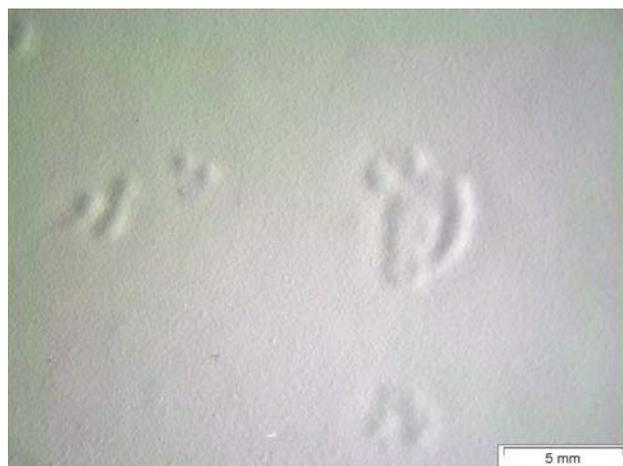
Figura 6.1. Defectos encontrados en las muestras de aluminio después de ser silanizadas por el método de un paso y pintadas.
