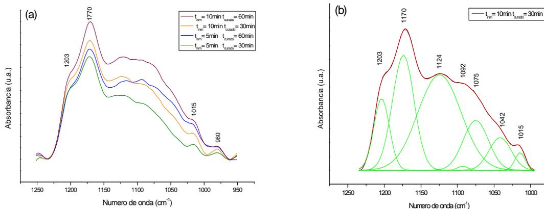
Figura 5.2. Detalle de la región entre  $1250\text{ cm}^{-1}$  y  $950\text{ cm}^{-1}$  (a) y deconvolución de la región entre  $1250\text{ cm}^{-1}$  y  $1000\text{ cm}^{-1}$  (b) de los espectros de RAIIR de los recubrimientos de silano MPS.
