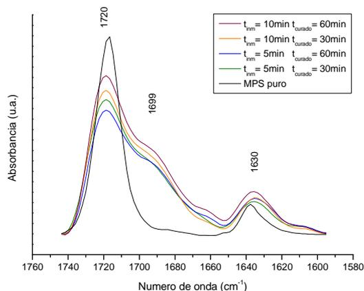
Figura 5.3. Detalle de los espectros de RAIIR obtenidos para los recubrimientos de silano MPS sobre aluminio a partir de una disolución acuosa a pH 4 de MPS al 1% hidrolizada durante 60 min. Tiempos de inmersión: 5 y 10 min. Tiempos de curado: 30 y 60 min.
