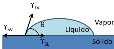
Figura 3.6. Tensiones superficiales en una gota de líquido depositada sobre un sólido.
