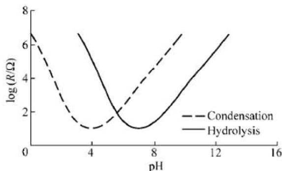
Figura 1.2. Velocidad de hidrólisis y condensación para un silano<sup>57</sup>.
