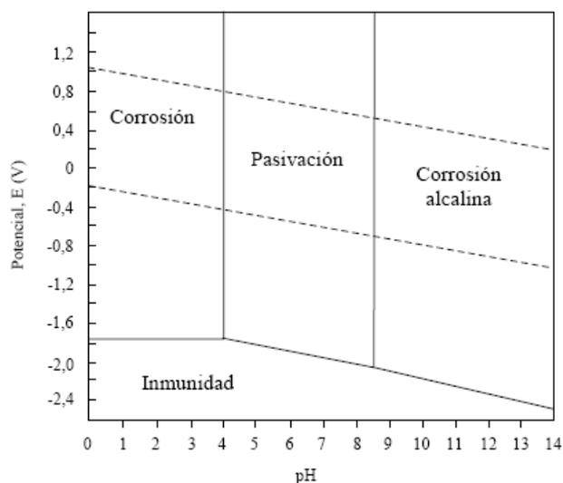
Figura 1.1. Diagrama de Pourbaix del aluminio a 25 °C.
