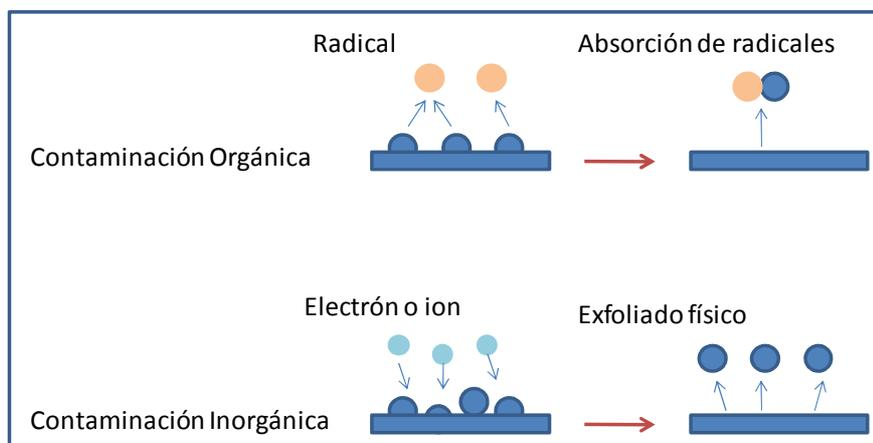
Figura 1.6. Efecto de limpieza del plasma sobre el sustrato metálico.
