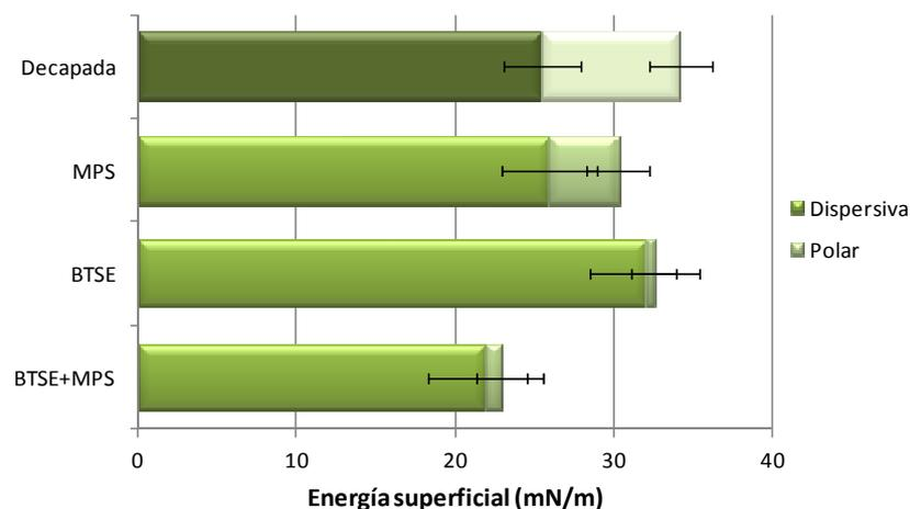
Figura 5.17. Energía libre superficial total, así como sus componentes polar y dispersiva, para la muestra decapada, silanizadas en un paso con una disolución MPS o de BTSE y en dos pasos con BTSE y MPS.
