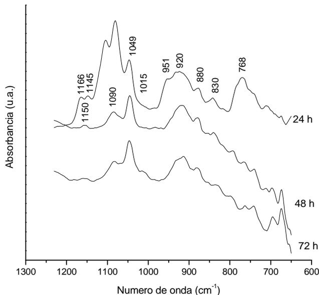
Figura 4.12. Espectros ATR de la *disolución 3* tras tiempos de hidrólisis de 24, 48 y 72 h.
