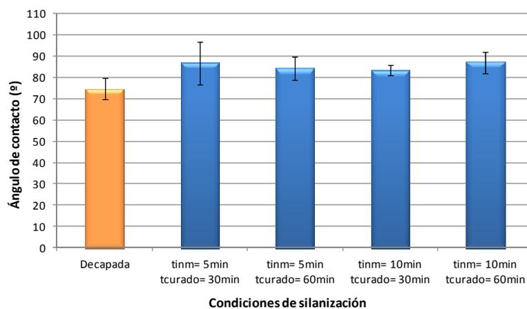
Figura 5.14. Comparación de los valores de ángulo de contacto con agua obtenidos para la muestra decapada y las muestras silanizadas con una disolución de BTSE al 1% en agua (93%) y metanol (6%) hidrolizada durante 72 h, tiempos de inmersión de 5 min y 10 min y tiempos de curado de 30 min y 60 min a 100 °C en estufa.
