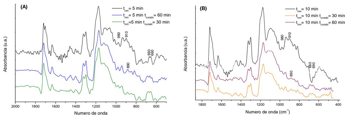
Figura 5.4. Espectros de RAIIR de las muestras silanizadas por inmersión en una disolución acuosa a pH 4 de MPS al 1% hidrolizada durante 60 min, frescas y curadas en estufa a  $100\text{ }^{\circ}\text{C}$  durante 30 y 60 min. Tiempos de inmersión: (A) 5 min y (B) 10 min.
