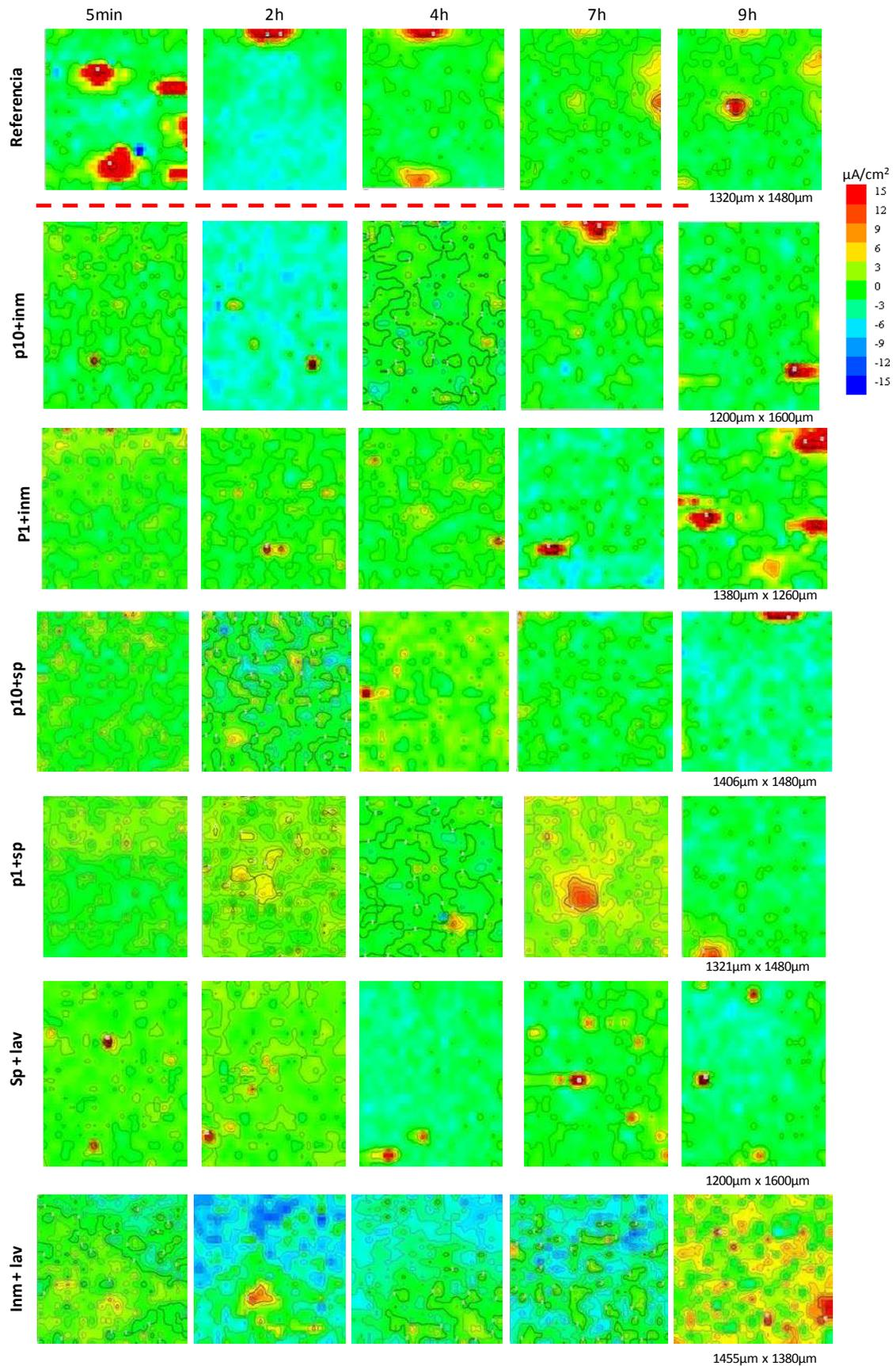
Figura 8.11. Mapas de SVET para las muestras silanizadas en un paso.
