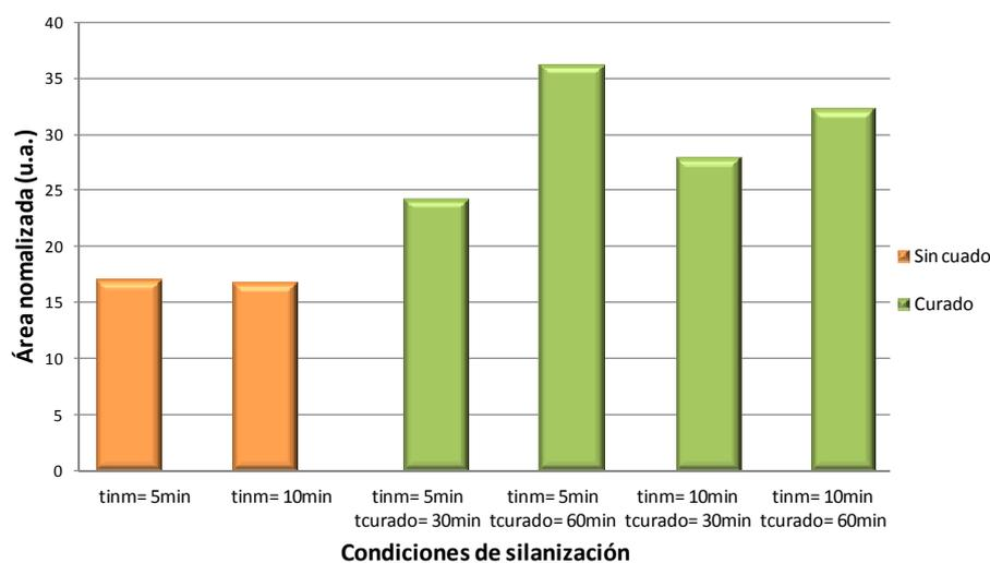
Figura 5.19. Área normalizada de la región comprendida entre  $1150$  y  $950\text{ cm}^{-1}$  para muestras silanizadas con MPS en tiempos de inmersión de 5 y 10 min. Se compara además el efecto del curado a tiempos de 30 y 60 min a  $100\text{ °C}$  en estufa.
