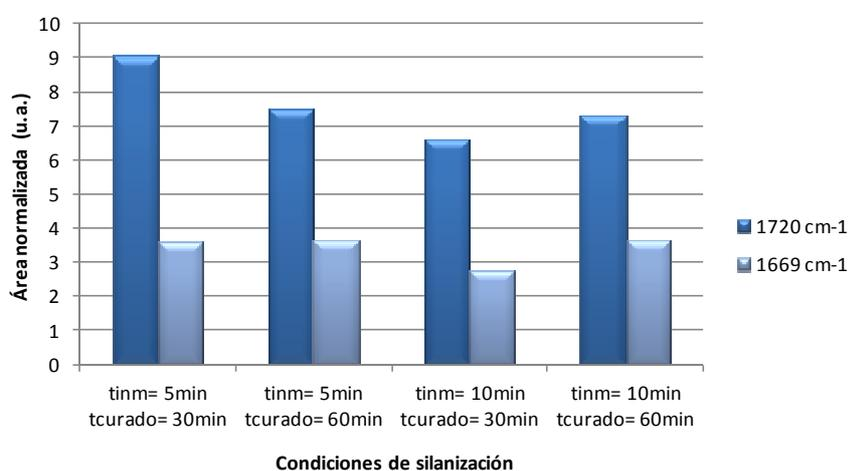
Figura 5.21. Resultados de la integración de las bandas a 1720 y 1698 cm<sup>-1</sup> de los espectros de RAIR obtenidos para las capas de silano sobre aluminio a partir de una disolución acuosa a pH 4 de MPS al 1% hidrolizada durante 60 min. Tiempos de inmersión: 5 y 10 min. Tiempos de curado: 30 y 60 min.
