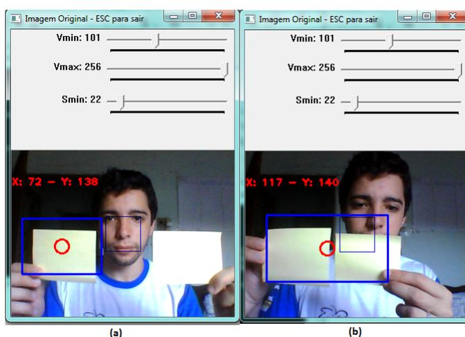
Figura 32 – (a) Camshift sem interferência (b) Camshift com interferência
