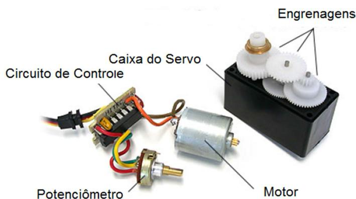
**Figura 14** – Componentes internos de um Servomotor
