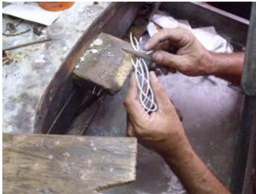
Primeiro retirou o resto de papel que serviu de guia para o recorte. Pegou uma lima, ferramenta usada para retirar excessos. Começou então a limar a chapa recortada. Trocou por uma menor e continuou limando.
