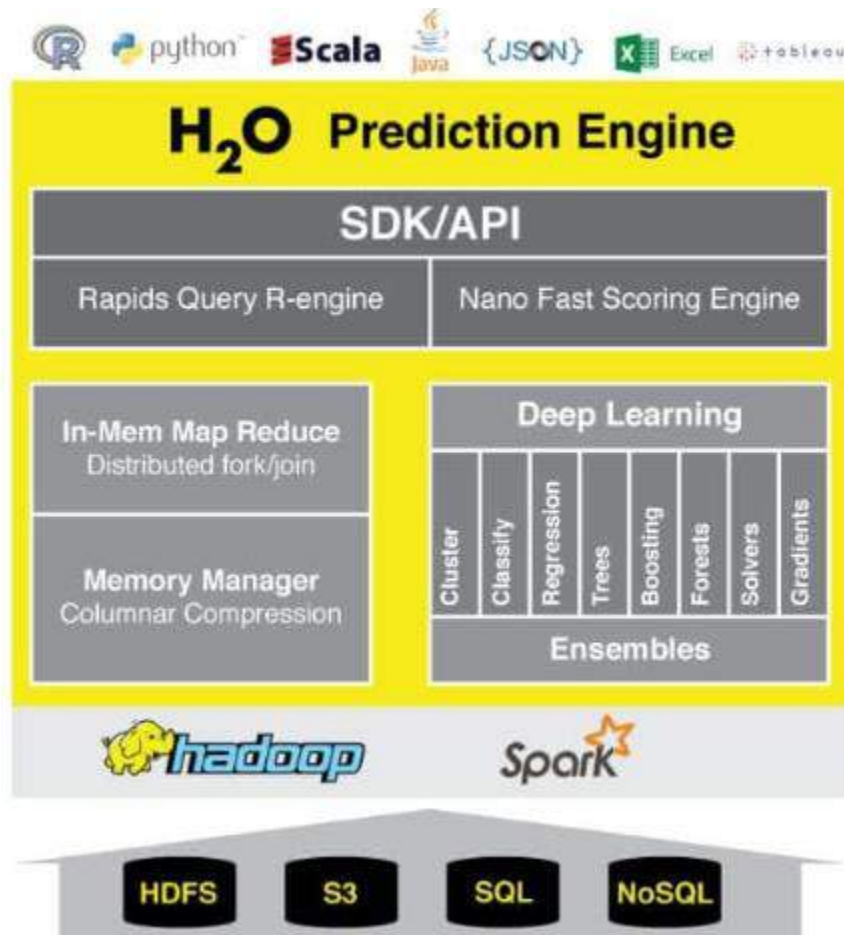
Figura 15: Estructura del motor de predicción H2O
