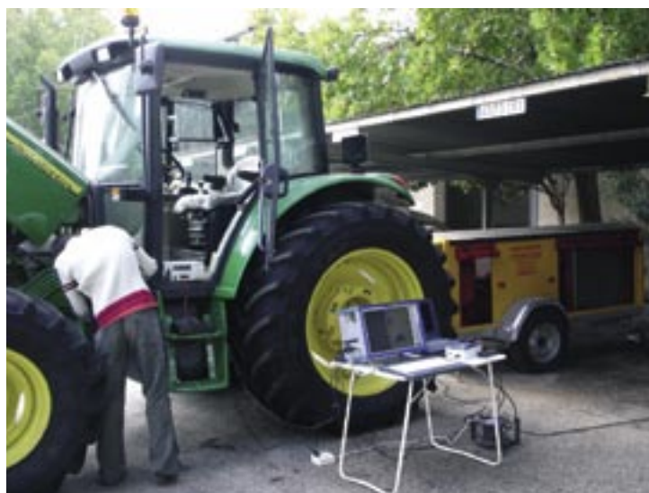
Figura 3. Ensayo del motor del tractor a la tdf mediante un freno dinámico móvil.
