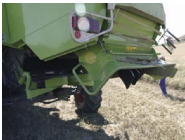
Detalle de distribuidor de paja picada y esparcidor de granza y tamo.
