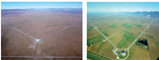
Fig.3. Imagen aérea del detector interferométrico de LIGO en Hanford (4 kilómetros de brazo), Washington (izquierda) y del detector VIRGO en Pisa (3 kilómetros de brazo), Italia (derecha).
