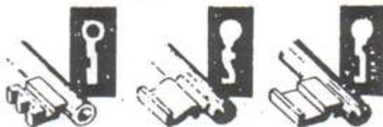
Estas cerraduras "SIMPLES", normalmente se utilizan en puertas internas de casas generalmente antiguas. Cabe destacar que este tipo de cerraduras no representan ningún margen de seguridad.
