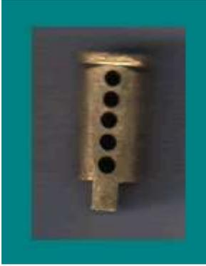
Para su reparación tendremos que colocar una llave virgen completamente dentro del cilindro, con esta en el interior ,tendremos que golpear el lado lateral del cilindro ,la idea es que esta vuelva a su posición normal de luz para el contar el punto justo de luz deberemos introducir y sacar continuamente la llave hasta que notemos que la misma trabaje libremente.
