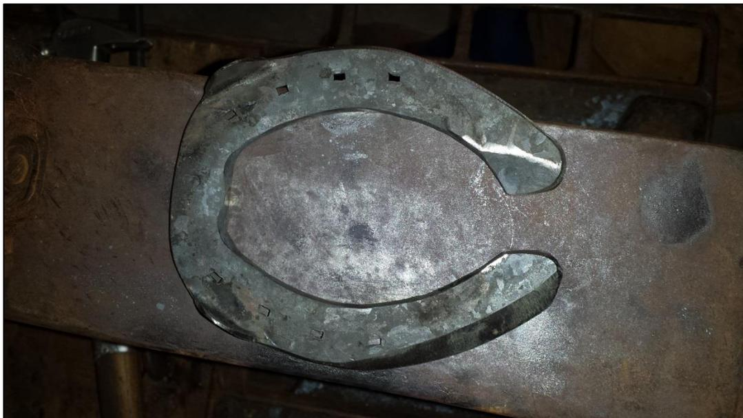
Figura 20. Ferradura com extensão lateral.
