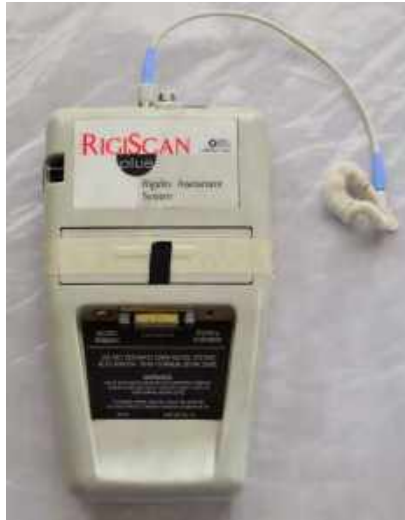
FOTO 1 equipo para realizar TRPN; el anillo se coloca en el pene del paciente.
