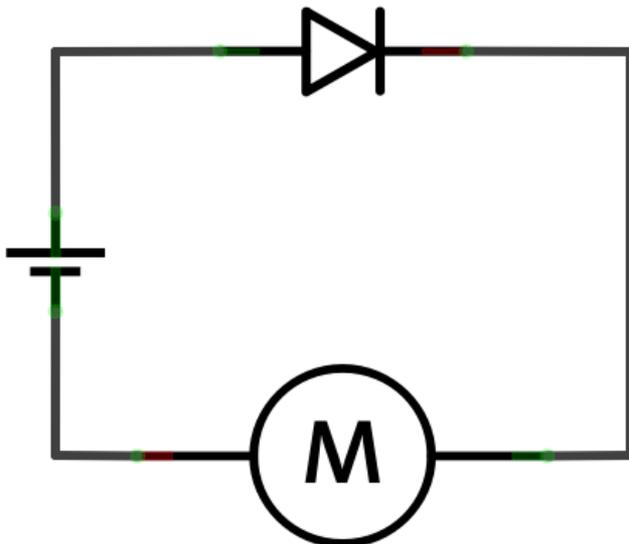
Diodo inversamente polarizado
