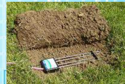
Medida humedad terreno
