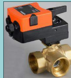
Válvulas para control de paso de agua caliente controladas por tensión 0-10V. Permite ajuste de paso de fluido variable .
