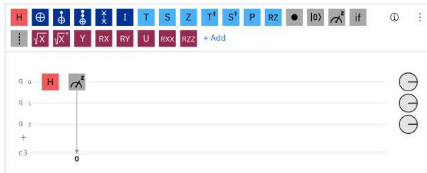
Figura 2.3: Ejemplo de un circuito con una puerta Hadamard y un medidor (Reimpresión cortesía de IBM Corporation ©)
