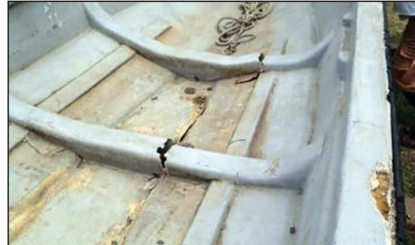
Daños en las cuadernas
