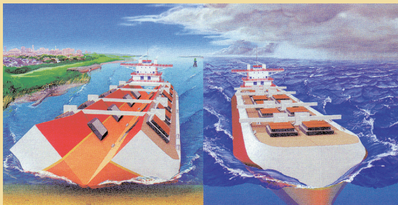
Impresión artística del buque "articulado" en sus dos configuraciones: a la izquierda para navegar en aguas poco profundas y, a la derecha, para aguas profundas
