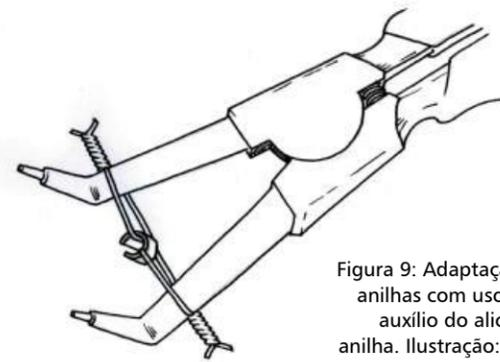
Figura 9: Adaptação do método de abrir anilhas com uso de arames finos, com auxílio do alicate especial para abrir anilha. Ilustração: Cristiano Nascimento.
