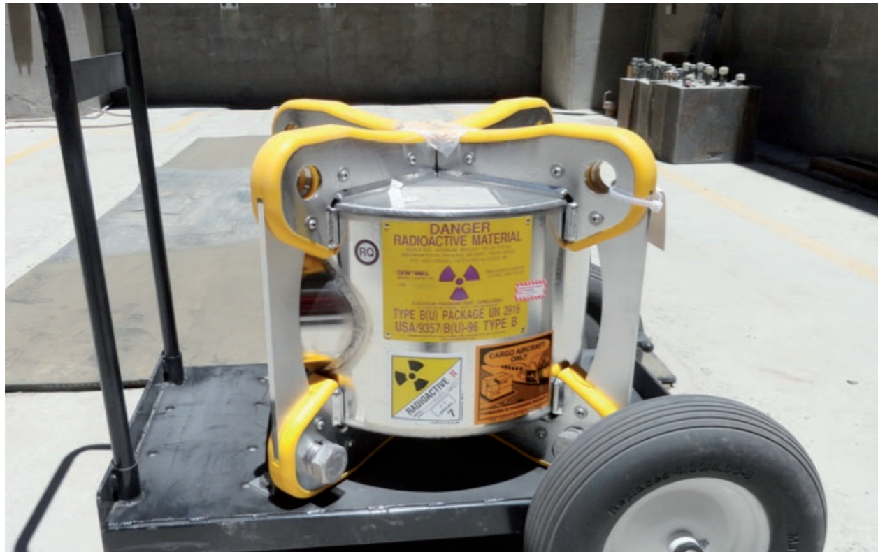
Figura 15: Equipo usado en minería de gammagrafía industrial.
