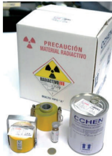
Figura 8: Bulto: Caja de cartón desechables que en su interior se encuentra el contenedor y blindaje utilizado para el transporte de la fuente radiactiva Yodo 131.
