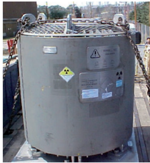
Figura 9: Bulto: Contenedor de material radiactivo en forma de varillas de Cobalto 60.
