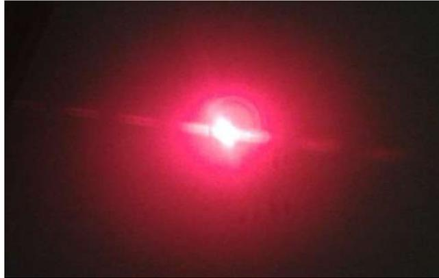
Figura 20: Difracción de un pelo.
