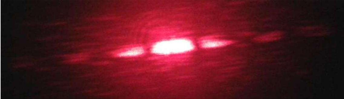
Figura 19: Interferencia a través de una rendija.
