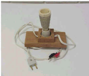
Figura 41: Incrustador elétrico de cera.
