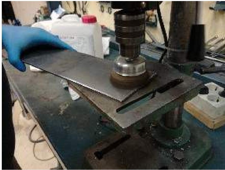
Figura 9.5: Proceso de preparación de superficies para el adhesivo.
