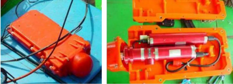
**FIGURA 12:** Transdutor da sonda de rede. Fonte: Laboratório de Tecnologia Pesqueira e Hidroacústica - Instituto de Oceanografia, FURG.
