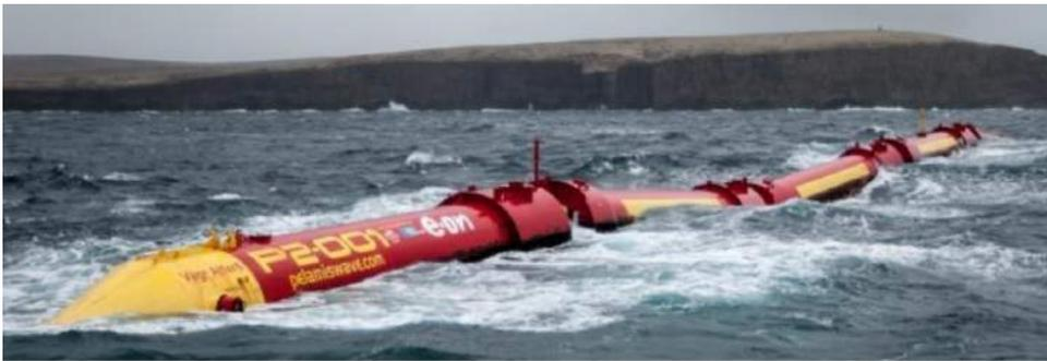
**FIGURA 12:** Atenuador de ondas Pelamis. Fonte: <http://www.emec.org.uk/about-us/wave-clients/pelamis-wave-power/>.
