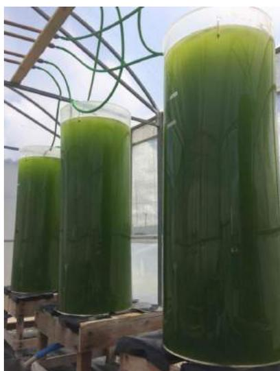
**FIGURA 8:** Fotobiorreatores para produção de microalgas com borbulamento. Estação Marinha de Aquicultura, Instituto de Oceanografia – FURG (Foto: F. Roselet).
