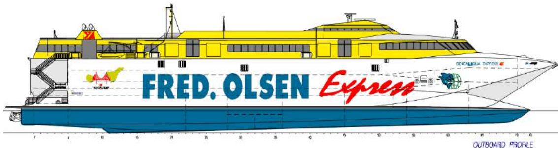
Los puntos de inundación progresiva que se pueden ver en el buque son las entradas de admisión de aire, concretamente 4 a lo largo de toda la eslora en cada costado.
