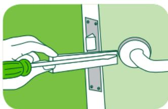
\* Retiramos los tornillos de sujeción con un destornillador (2 por cada lado).
