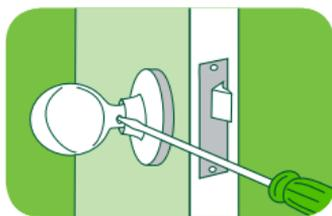
\* Retiramos los tornillos de sujeción con un destornillador (por cada lado) y ya podemos desmontar el pomo.
