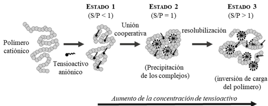
Figura 5.1. Representación esquemática de los tres estados en los que se pueden presentar los complejos polímero-tensioactivo de carga opuesta en disolución a medida que se aumenta la concentración de tensioactivo. Los estados 1 y 3 corresponden a disoluciones de carácter monofásico, mientras que el estado 2 es relativo a la precipitación de los complejos como consecuencia de la neutralización de carga por la asociación cooperativa polímero-tensioactivo [1, 4].
