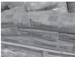
Pacotes com cimento Portland
