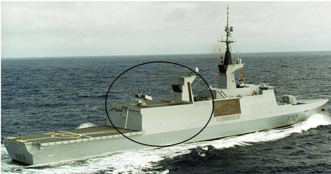
**Figura 28.** La Fayette, fragata con la superestructura en composite en la sección que se muestra en el círculo.
