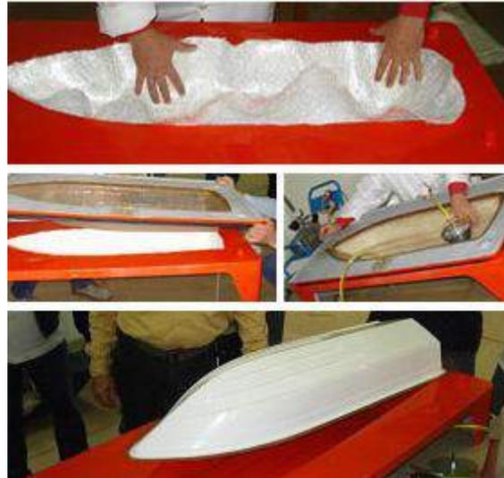
Figura 15. Moldeo por transferencia de resina (RTM). Inyección puntual.
