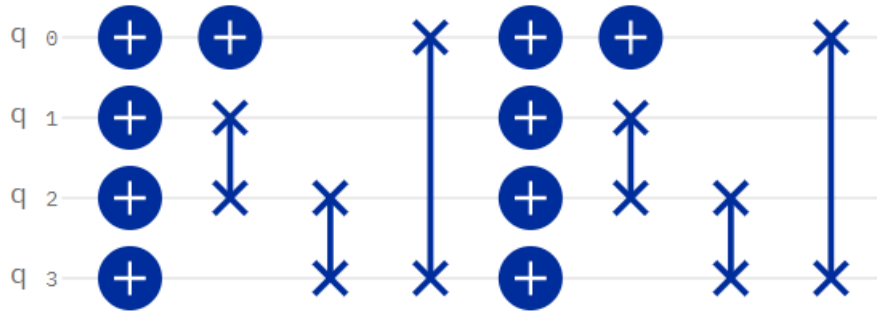
Figura 6.2: Circuito que implementa la operación U |\psi\rangle = |7^2 \psi \text{ mod}(15)\rangle
