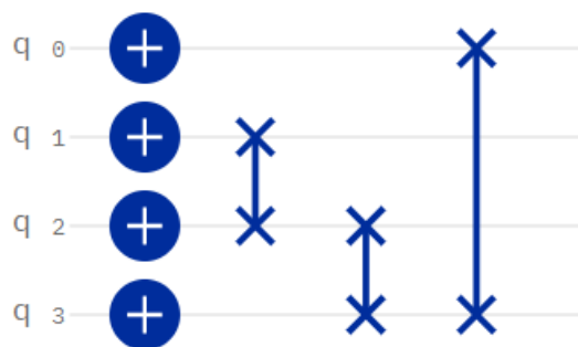
Figura 6.1: Circuito que implementa la operación U |\psi\rangle = |7\psi \bmod(15)\rangle
