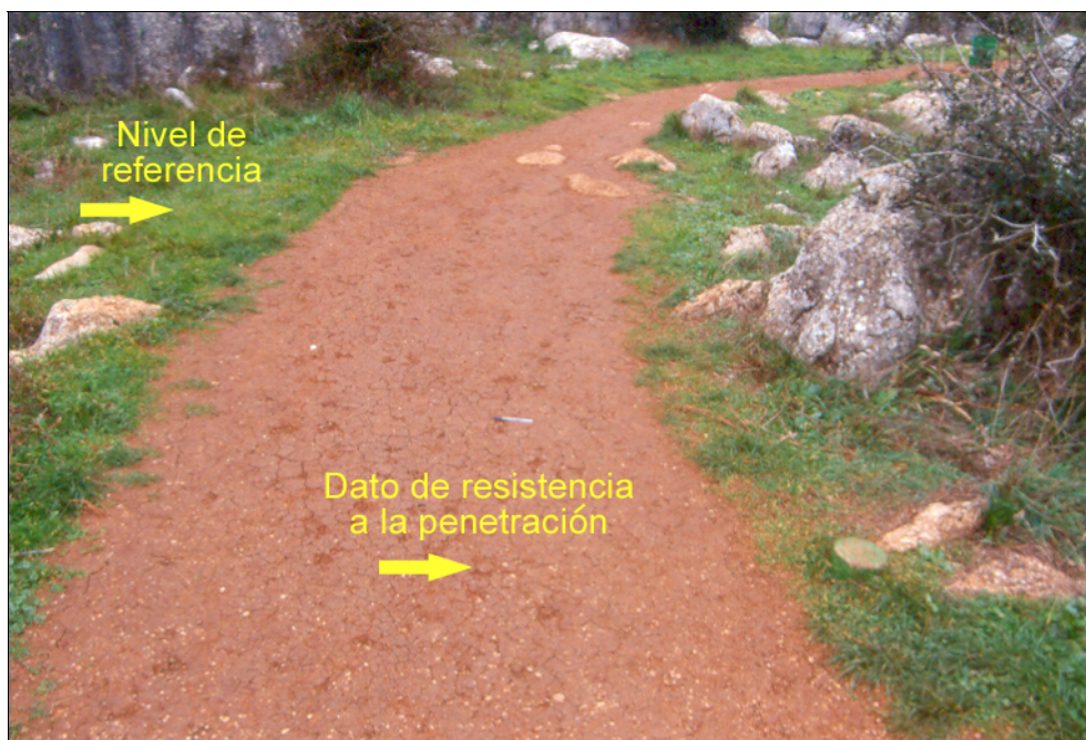
Figura 4.5: diseño seguido para la toma de datos de resistencia a la penetración en el Sendero Verde del Paraje Natural Torcal de Antequera (Málaga). Una vez obtenido el dato en el centro del trazado, se localizaba en el entorno próximo una zona representativa de suelo para tomar el dato de referencia.
