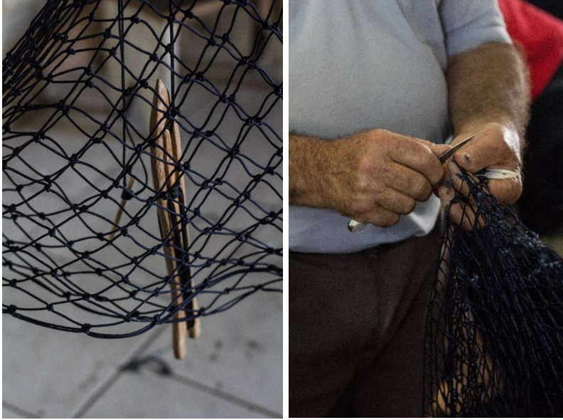
Figura 36. Materiais sendo utilizados ao remendar rede de pesca em Itajaí/SC.
