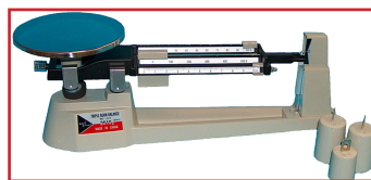
Figura 1. Tipos de balanzas. La analítica tiene mayor sensibilidad que la granataria.
