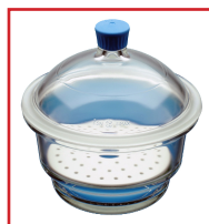
Figura 5. Desecador para proteger reactivos químicos de la humedad del medio ambiente.
