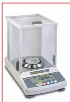
Figura 1. Tipos de balanzas. La analítica tiene mayor sensibilidad que la granataria.
