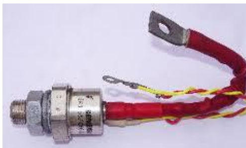
Figura 13 – Aspecto físico do SCR de potência
