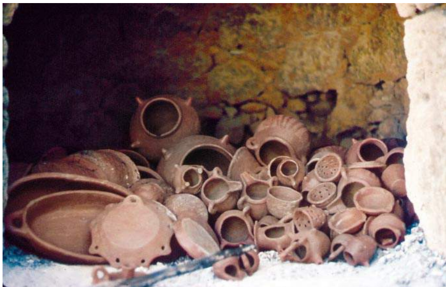
Las vasijas mayores van al fondo y las pequeñas en la boca.
