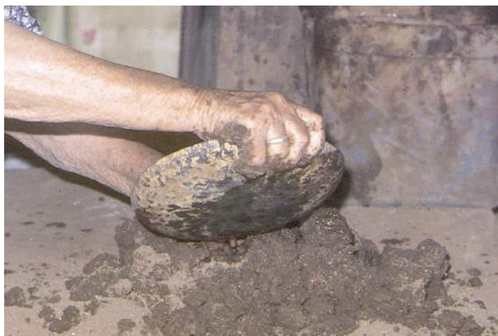
Mezclando el barro seco y cernido con la «levadura».
