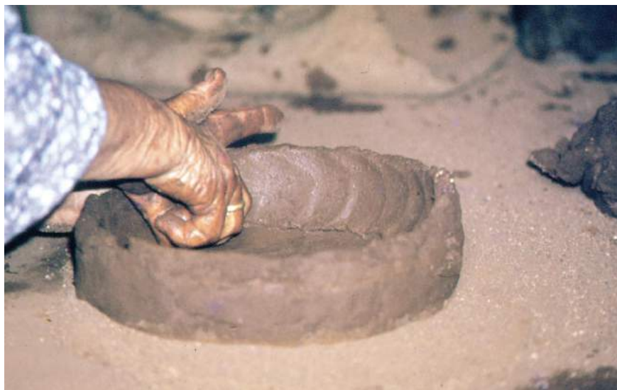
Estirando el bollo con movimientos verticales mientras la mano izquierda presiona para evitar el alargamiento de la base.
