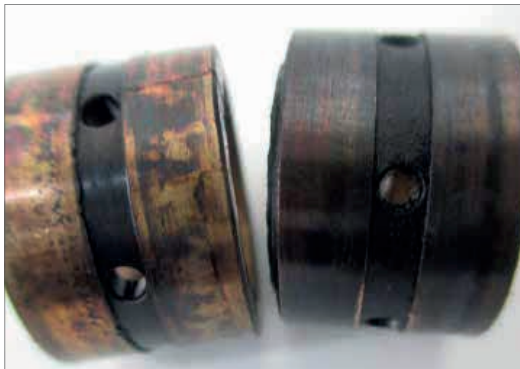
Fig. 22.1.1.1 – Lubrificação deficiente nos mancais radiais.
