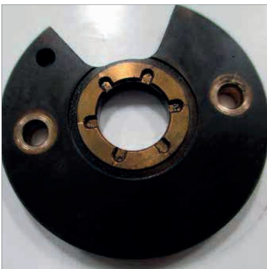
Fig. 22.3.1 – Carbonização do óleo lubrificante decorrente de temperatura elevada.
