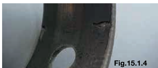
Marca externa provocada pelo corpo estranho
