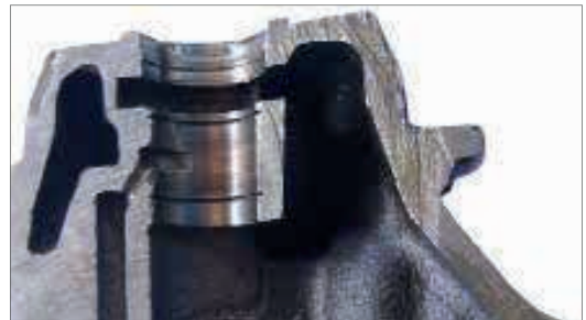
Fig. 22.1.1.3 – Riscos no alojamento da carcaça central.
