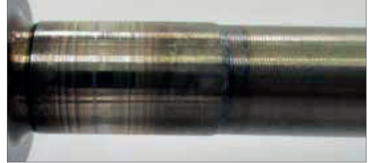
Fig. 22.1.2.2 – Riscos provocados por óleo lubrificante contaminado.
