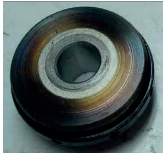
Fig. 22.1.1.4 – Lubrificação deficiente no colar centrífugo.
