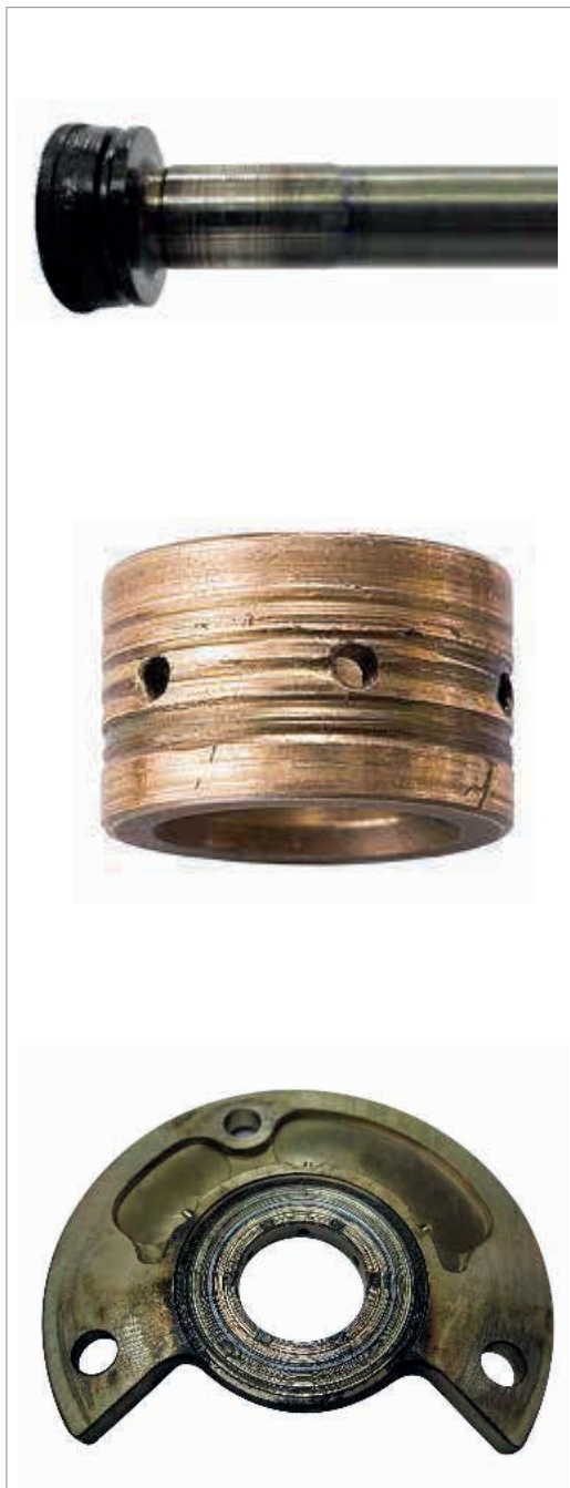
Fig. 22.1.2.4 (1) – Óleo lubrificante contaminado, Fig. 22.1.2.4 (2) – Eixo rotor, mancal radial e espessador e Fig. 22.1.2.4 (3) – Óleo lubrificante contaminado
