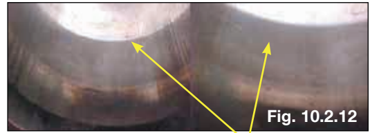
Fig. 10.2.12 Camisa "espelhada" devido à rotação constante
