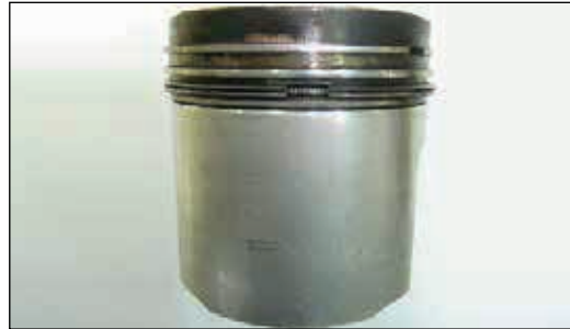
Pistão com características normais de funcionamento
