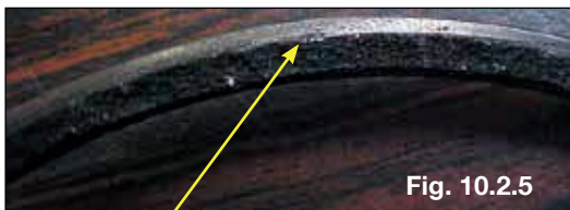
Região do colarinho da camisa carbonizado
