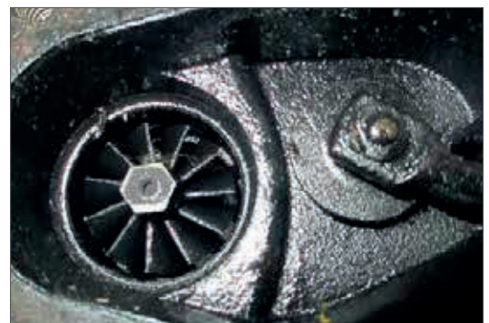
Fig. 22.4.4 – Óleo lubrificante na carcaça da turbina.
