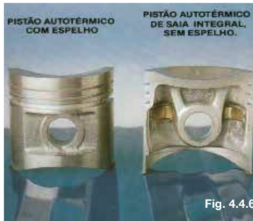
Fig. 4.4.5 Corte de um pistão autotérmico. Pode-se ver claramente a chapa de aço engastada no alumínio, formando um par.
