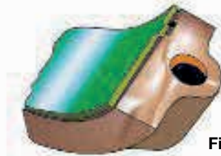
RESSALTOS DE CENTRAÇÃO NÃO COINCIDENTES
