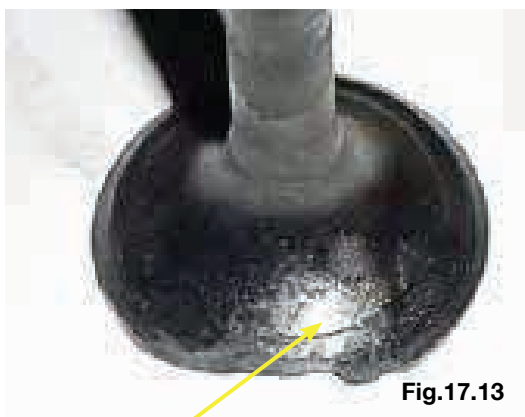
Parte da cabeça quebrada
