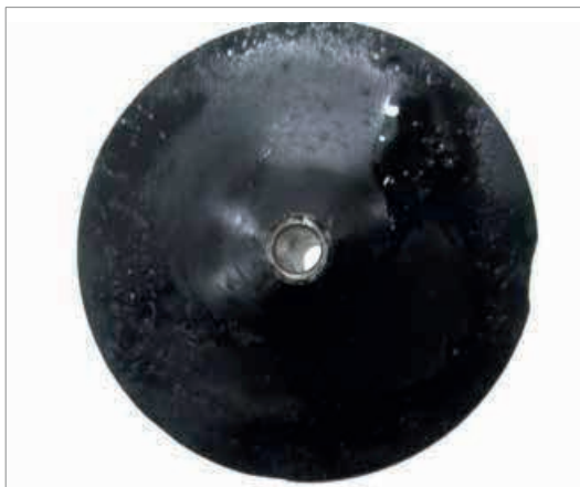
Fig. 22.5.1 – Borra de óleo lubrificante, provocado por restrição de ar.
