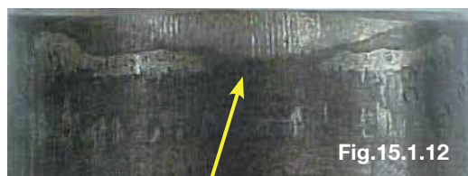
Marca do embuchamento inclinado
