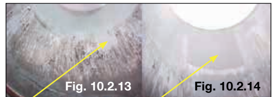
Fig. 10.2.13 Fig. 10.2.14 Engripamento originado pela diluição do óleo lubrificante existente na parede do cilindro
