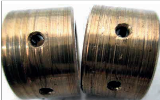
Fig. 22.1.2.1 – Riscos provocados por óleo lubrificante contaminado.
