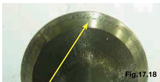
Desgaste na região da cabeça da válvula
