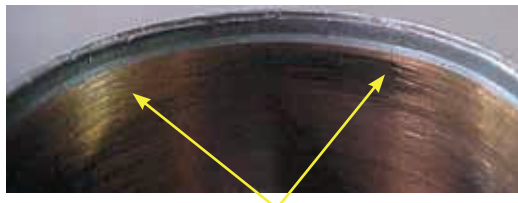
Riscos normais e espessura correta da parede
