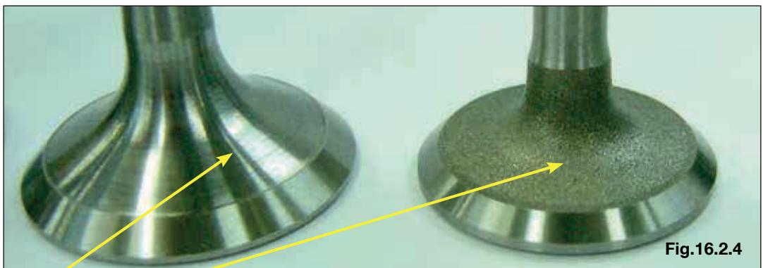
Cabeça retificada e sem ser retificada
