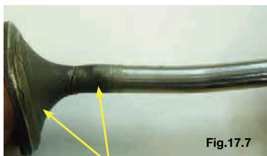
Válvula deformada e quebrada na região do raio e haste
