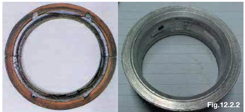
Flange totalmente desgastado
