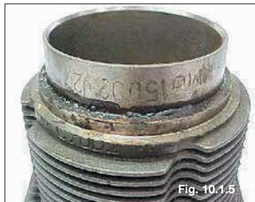
Camisa montada com cola na base inferior
