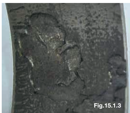
Marca interna provocada pelo corpo estranho
