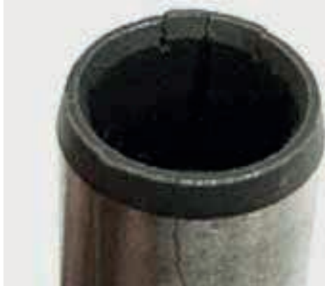
Detalhe da quebra do diâmetro interno
