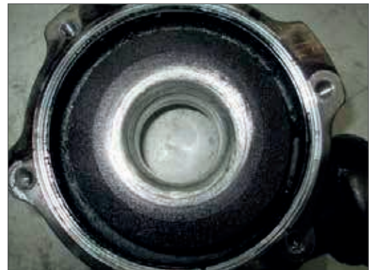
Fig. 22.4.3 – Borra de óleo na carcaça compressora.
