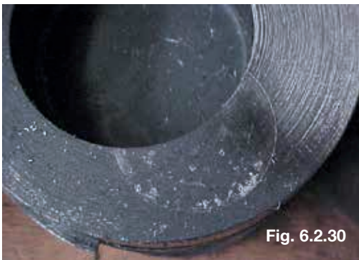
Marca de válvula no topo usinado do pistão
