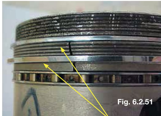
Parede entre canaleta fraturada em pistão aplicado em motor Ciclo Otto
