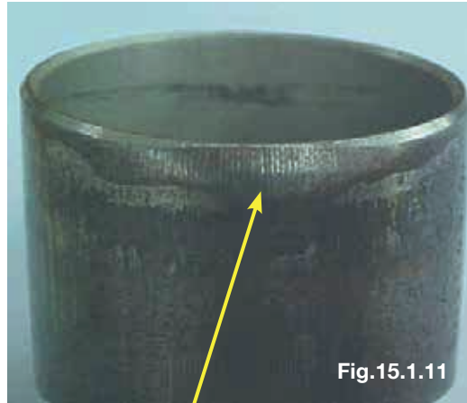
Marca do embuchamento inclinado
