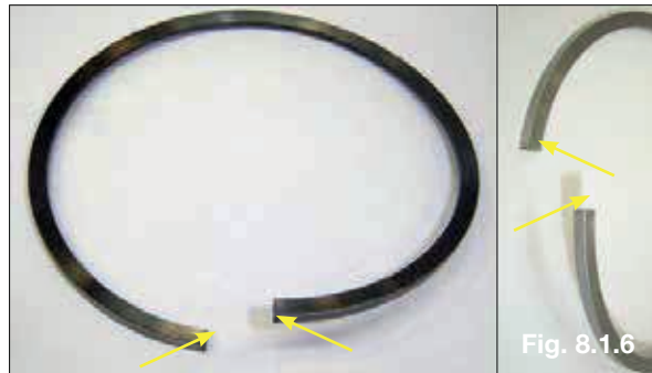
Pontas desalinhadas devido à montagem incorreta
