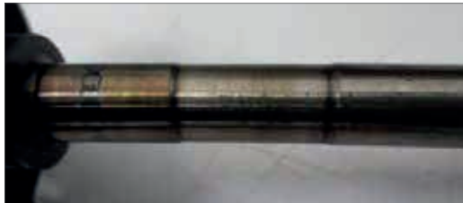
Fig. 22.1.1.6 – Marcas circulares no eixo, indicio de parada a quente.
