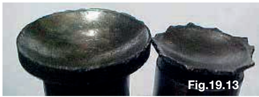
Detalhe de desgaste e quebra da base
