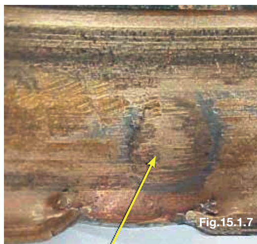
Marca interna provocada pelo corpo estranho
