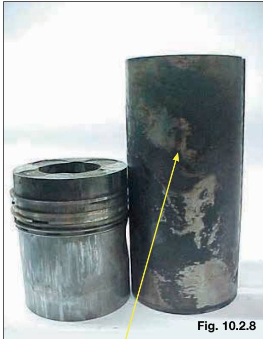
Fig. 10.2.8 Marcas escuras no lado externo da camisa, identificando a falta de interferência com o alojamento.
