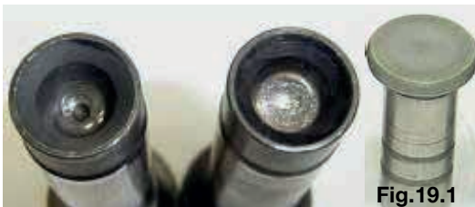
Tucho mecânico com desgaste normal de funcionamento
