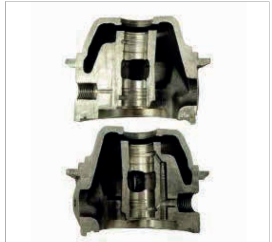
Fig. 22.1.2.3 – Carcaça central com riscos causados por impurezas.
