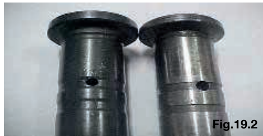
Desgaste na região da base
