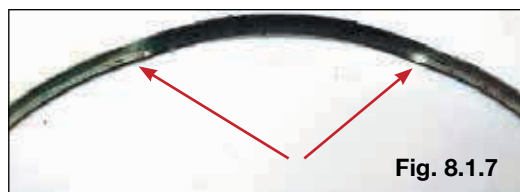
Anel montado torcido
