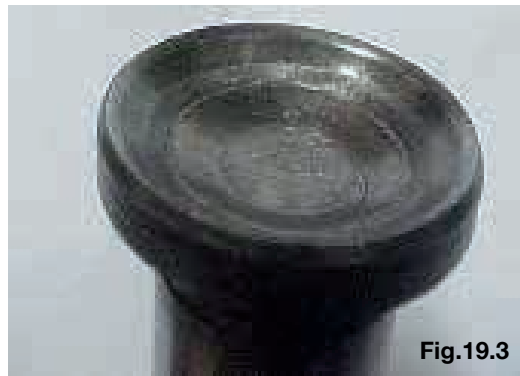
Desgaste excessivo da base
