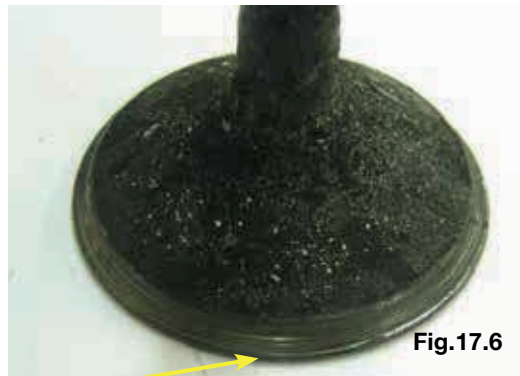
Desgaste na região do assento da válvula
