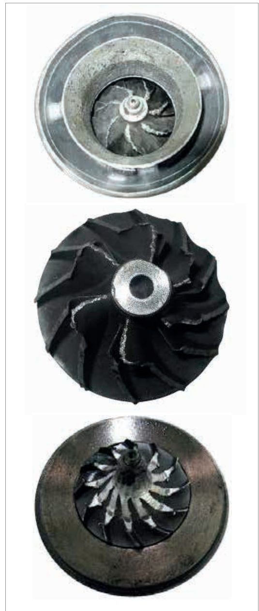
Fig. 22.2.2 (1), Fig. 22.2.2 (2) e Fig. 22.2.2 (3) – Admissão de corpo sólido
