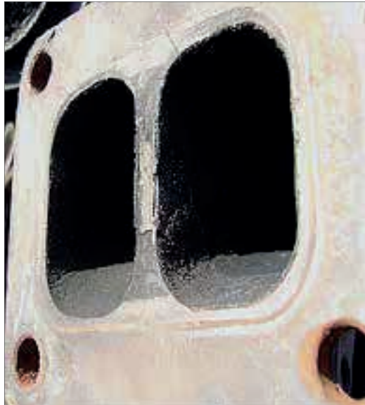
Fig. 22.3.2 – Trincas e escamação da carcaça.
