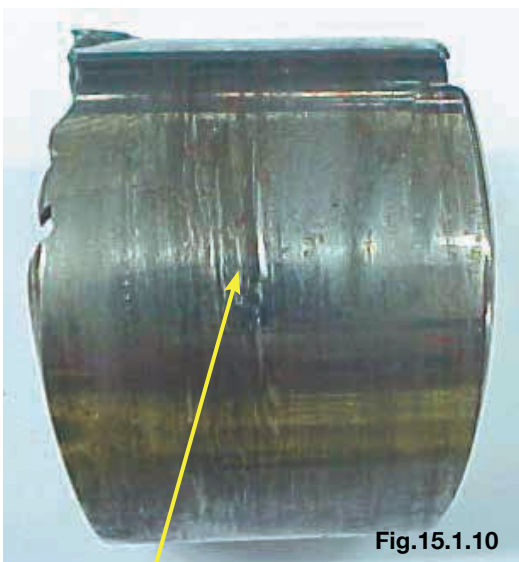
Marca do embuchamento incorreto
