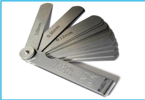
Figura 15. Calibrador de láminas. Fuente: Recuperado de <https://es.wikipedia.org>
