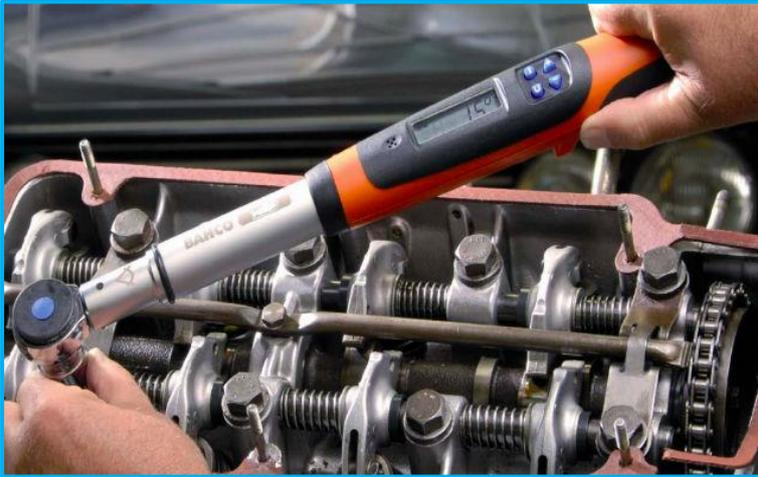
Figura 24. Torquímetro. Fuente: Recuperado de <http://www.demaquinasyherramientas.com>
