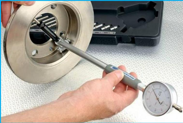
Figura 45. Medición con Alexómetro. Fuente: Recuperado de <http://www.bt-ingenieros.com>
