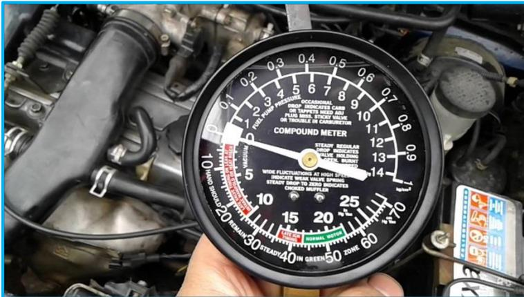
Figura 40. Vacuómetro. Fuente: Recuperado de <http://www.infotaller.tv>
