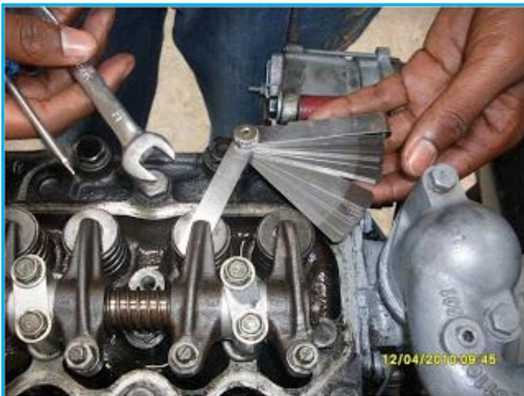
Figura 14. Medición con galgas. Fuente: Recuperado de <http://mmotoresdieselpopayan.blogspot.com>
