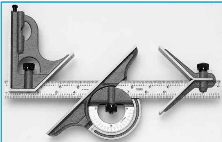
Figura 32. Escuadra de combinación. Fuente: Recuperado de <http://www.demaquinasyherramientas.com>
