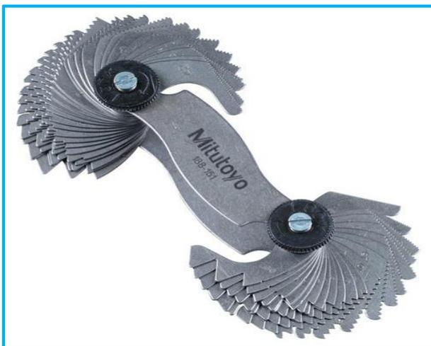
Figura 22. Verificador de pasos de roscar. Fuente: Recuperado de <http://www.lasmalvinas.pe>
