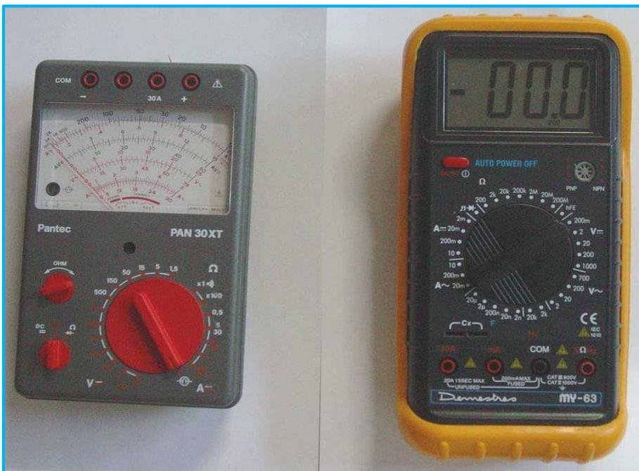
Figura 36. Multímetro analógico y digital. Fuente: Recuperado de <https://es.wikipedia.org>
