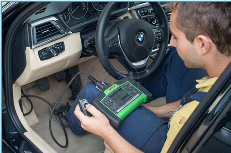
Figura 50. Uso del scanner. Fuente: Recuperado de <http://autodiagnostico.pe>
